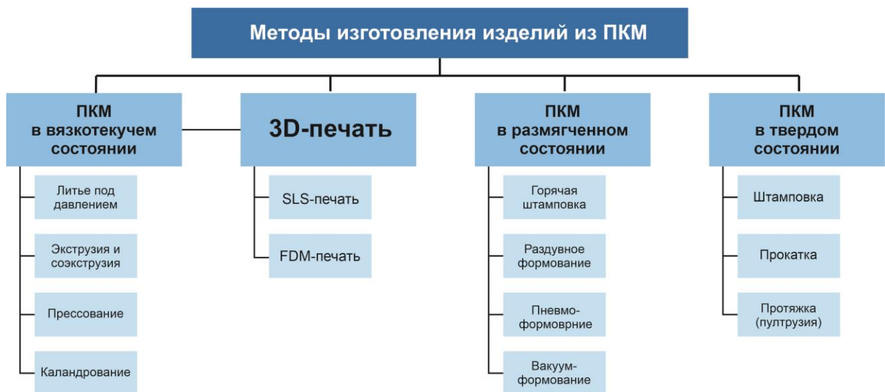
Рис. 4. Методы изготовления изделий из полимерных композиционных материалов
