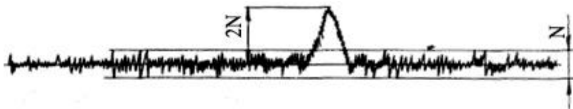
Рисунок 9. Шум детектора и наименьшее детектируемое количество соединения: N — уровень шума; 2N — наименьшее детектируемое количество соединения
