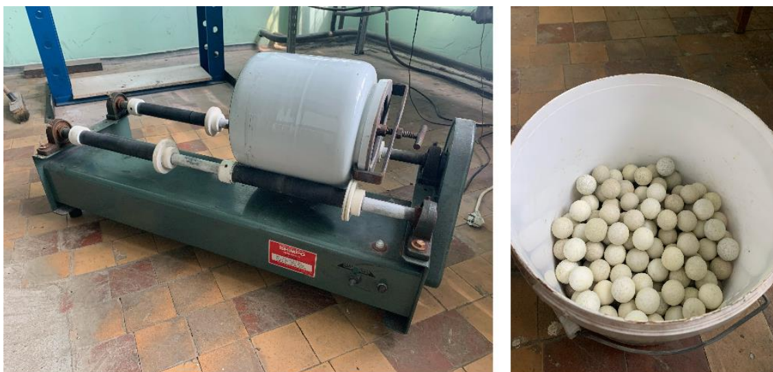
Рис. 5. Шаровая мельница
