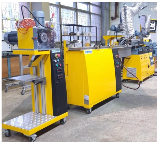
Рис. 7. Линия компаундирования термопластичных композиционных материалов на основе двухшнекового экструдера LTE20-44
