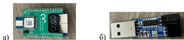
Рис. 1. Фотографии модулей: а) якорные станции; б) USB для сервера.
