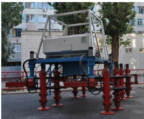
**Рис. 1.** Шагающий робот «Ортоног»
