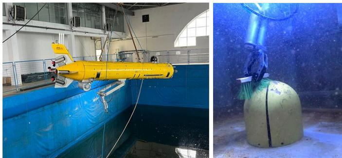
**Рис. 1.** Испытания АНПА ММТ-3500, оснащенного ММ и разработанной СУ
