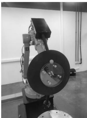
**Рис. 1.** Манипулятор с системой «шар на диске»
