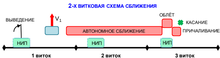
Рис. 1. Циклограмма 2-х витковой схемы стыковки
