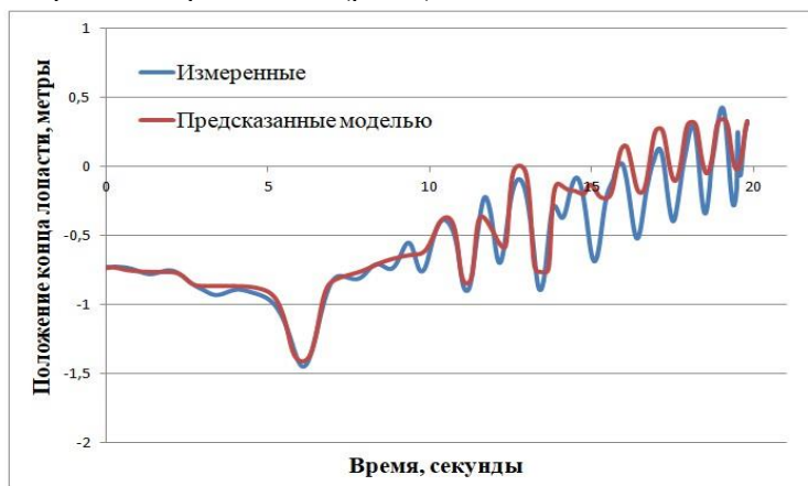
Рис. 2 Нейросетевое моделирование раскрутки лопасти с использованием информации о синусоидальной составляющей, обусловленной ветром
