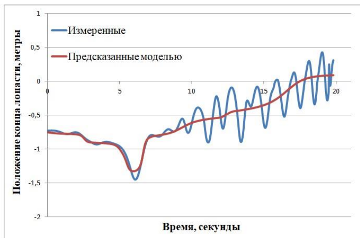
Рис. 1 Нейросетевое моделирование раскрутки лопасти без использования информации о гармонических составляющих, обусловленных ветром
