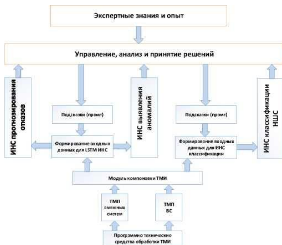
Рис. 1. Архитектура интеллектуализированной системы анализа ТМИ
