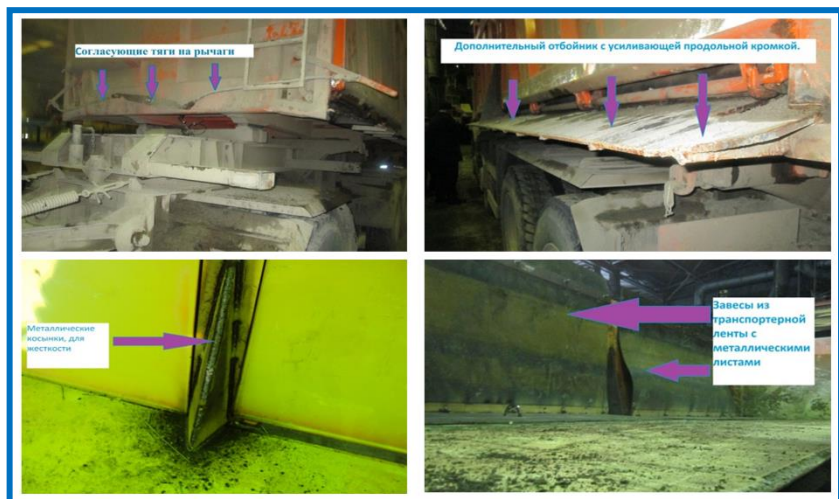
Рис. 4. Элементы кузова автопоезда Scania после модернизации, с учетом зимних условий эксплуатации на предприятиях АК «АЛРОСА»
