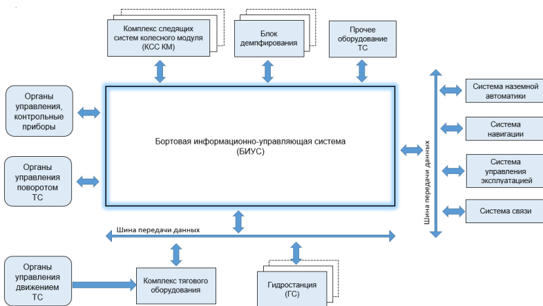
Рис. 2. Структурная схема взаимных связей между БИУС и агрегатами (узлами шасси), специальными системами и комплексами
