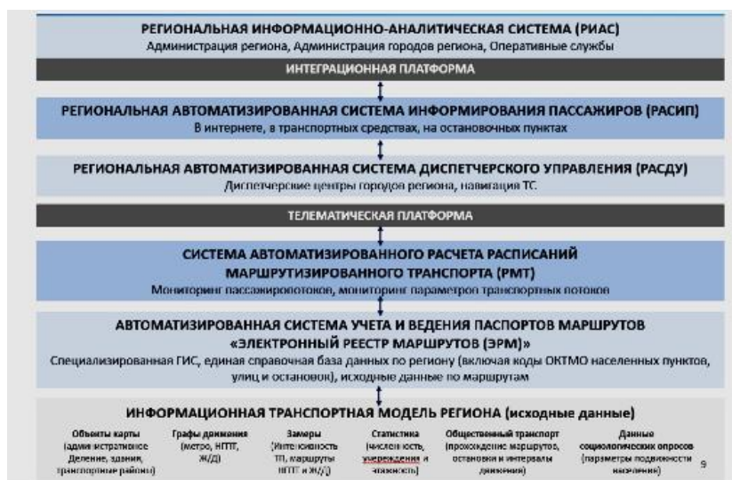
Рис. 5. Структура и взаимодействие основных компонентов комплексной автоматизированной системы диспетчерского контроля и учета транспортной работы на пассажирском транспорте
