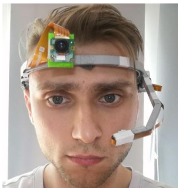
Рис. 2. Специализированное устройство, предназначенное для отслеживания движений глаз.
