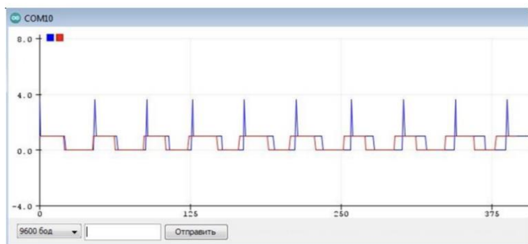
Рис. 2. Диаграмма корректировки времени работы интеллектуального светофора для ситуации, когда на перекрёстке находятся 7 автомобилей и 3 пешехода
