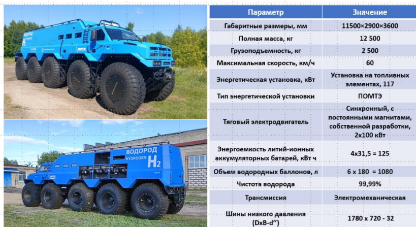
Рис. 1. Основные технические характеристики объекта исследования – перспективного транспортного средства FCEV
