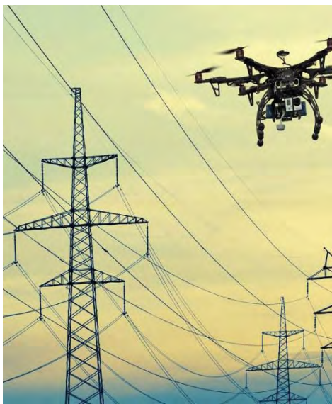
Рис. 4 Дистанционный мониторинг ВЛ с БПЛА
