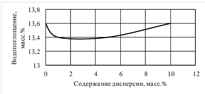
Рис. 3. Зависимость водопоглощения образцов от содержания дисперсии
