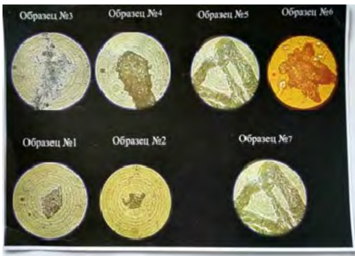
Рис. 3. Микроскопические остатки и окраска, определяемая содержанием битуминозных веществ, наблюдаемые при исследовании белорусской нефти.
