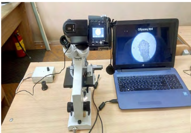
Рис.1. Установка, состоящая из бинокулярного микроскопа (МИКМЕД-1), фотокамеры (Nikon Cool Pix 4500) и компьютера.
