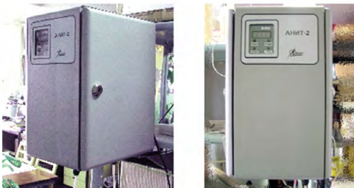
Рис. 4. Стационарная береговая автоматическая станция многокомпонентного контроля качества поверхностных вод
