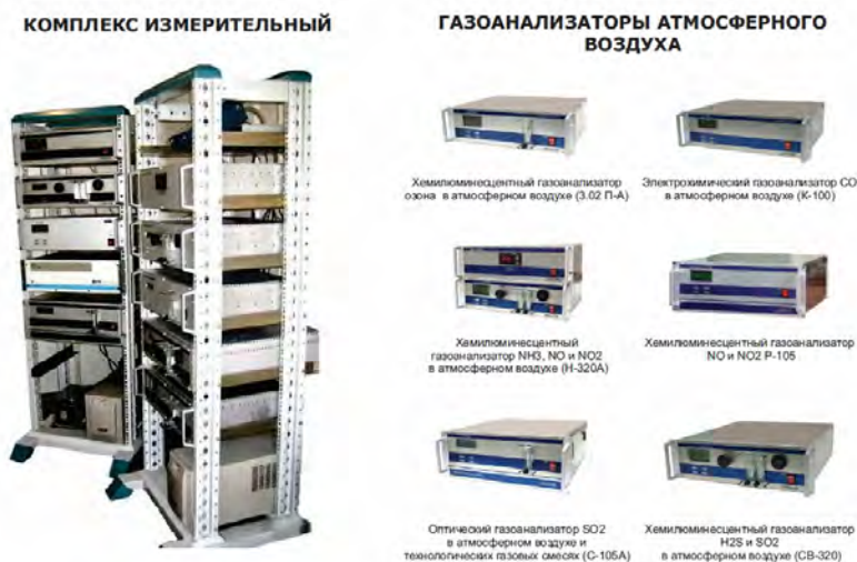
Рис. 2. Оборудование для стационарного поста мониторинга загрязнения атмосферного воздуха
