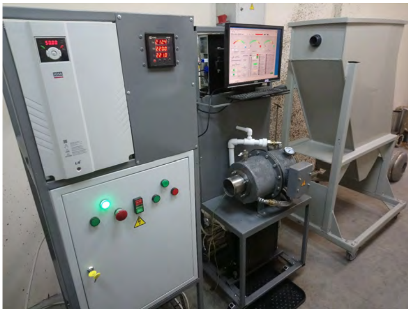
Рис. 1. Установка по переработке навоза с применением аппарата обработки во вращающихся магнитных полях
