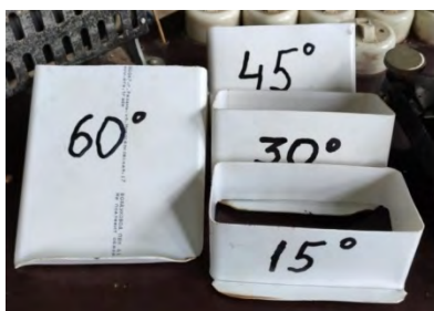
Рис. 2. Разработанные и изготовленные модели мундштуков на всасывающее сопло
