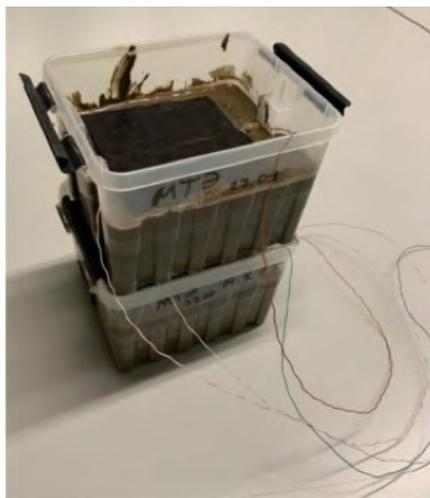
Рис. 2. Микробный топливный элемент второй модификации
