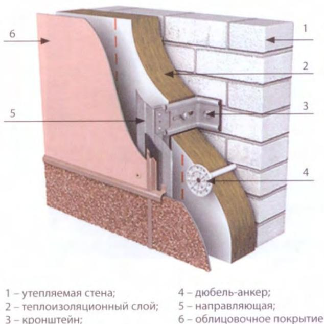
Рис. 2. Конструкция навесного вентилируемого фасада
