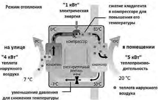
Рис. 1. Принципиальная схема теплового насоса.
