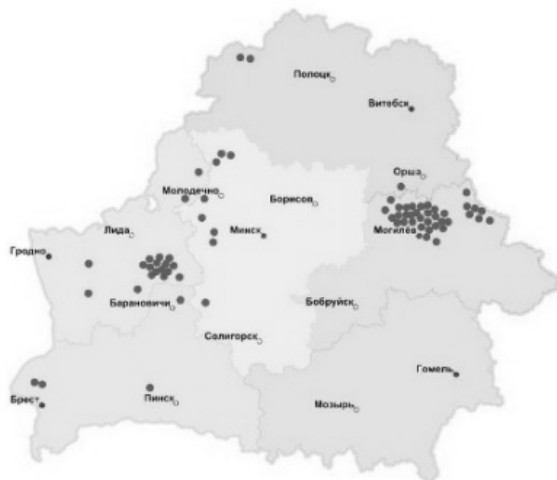
Рис. 4. Схема размещения ветровых установок
