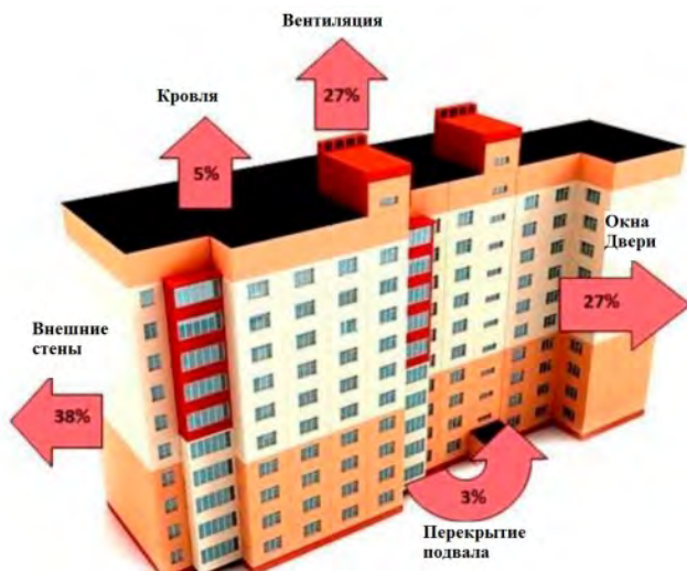
Рис. 1. Тепловые потери многоквартирного дома
