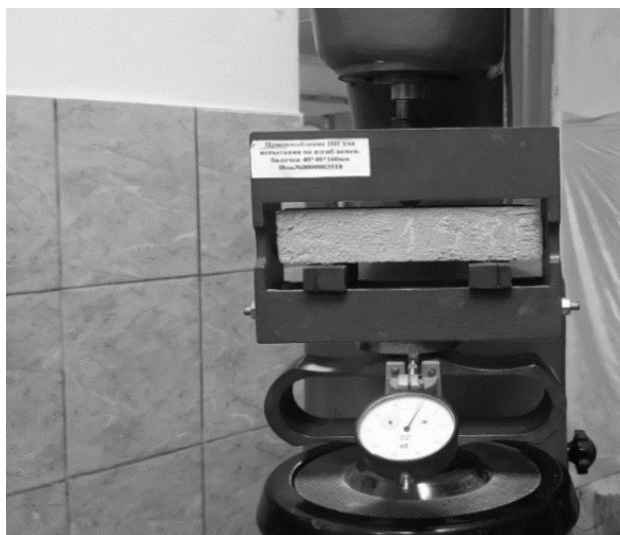
Рис. 1. Испытания образцов пенобетона на изгиб на установке ТШ-2
