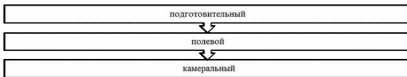
Рис. 1. Этапы проведения крупномасштабной топографической съемки
