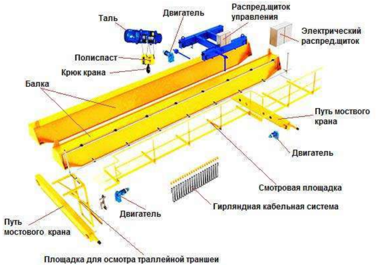
Рисунок 1.3 – Общее устройство мостового крана
