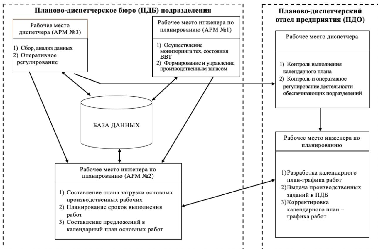
Рисунок 3.10 - Организационно-техническая структура АИС ОПП
