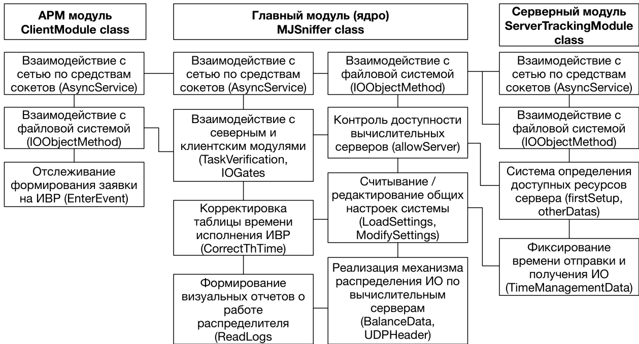
Рис. 4. Структура модулей монитора-распределителя ИВР TiCloudBalancer
