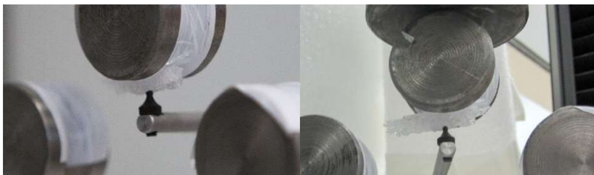
Рисунок 6.51 – Фрагмент стержня под индентором, прижатый к оснастке датчиком перемещений после разрушения образца
