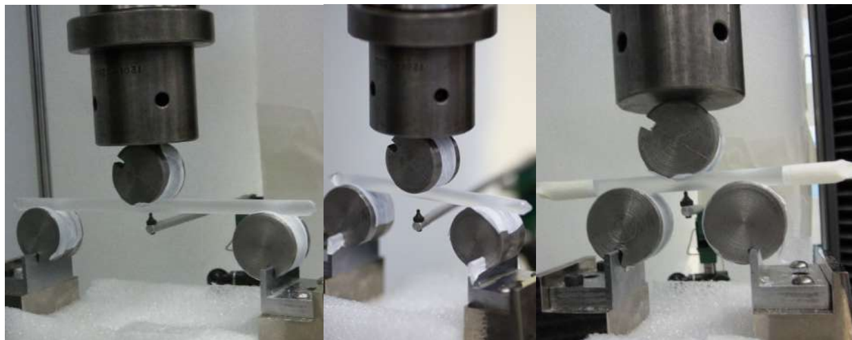
Рисунок 6.39 – Схема натурного эксперимента на разрушение по схеме трехточечный изгиб, с разными базами
