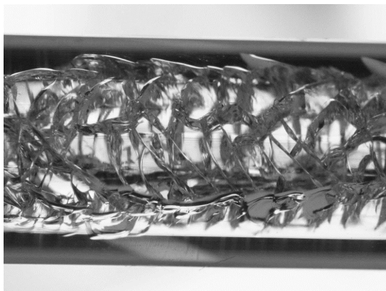
Рисунок 6.20 – Разрушение заготовки силового стержня
