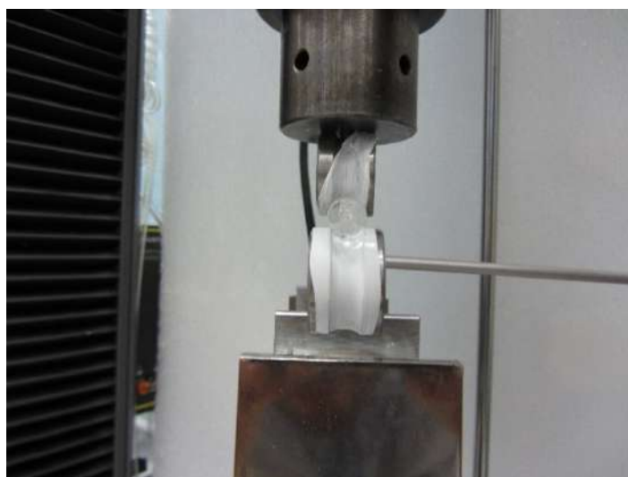
Рисунок 6.40 – Оснастка с проточками, для реализации схемы трехточечного изгиба с цилиндрическими образцами
