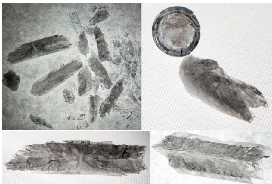
Рисунок 6.41 – Фрагменты силовых стержней после разрушения
