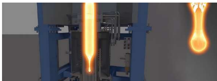
Рисунок 1.7 – Разогретая преформа для вытяжки волокна в вытяжной колонне (слева); формирование капли (справа)
