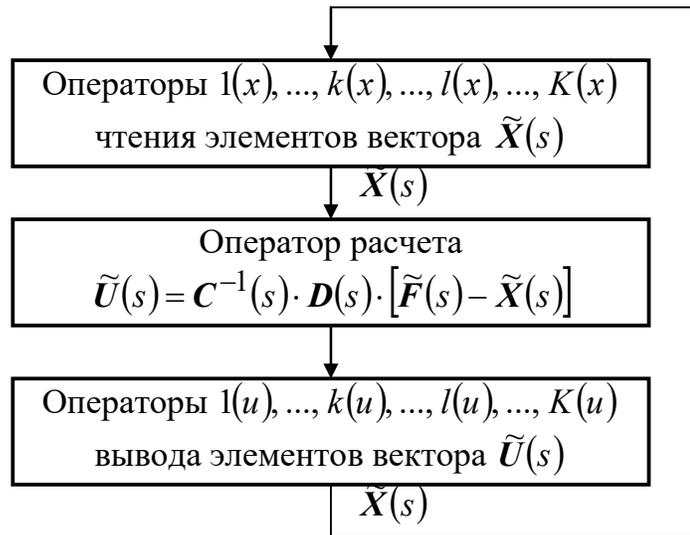
Рис. 3.8. Структура простейшего управляющего алгоритма
