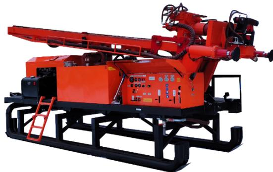
Рис. 1.6. Установки разведочного бурения УРБ на санях
