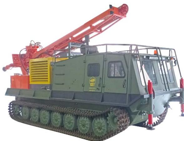
Рис. 1.5. Установки разведочного бурения УРБ на МТЛБу
