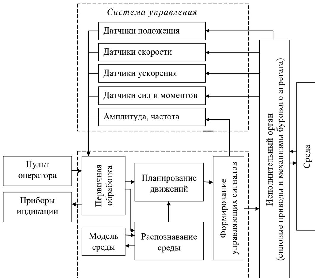
Рис. 1.12. Структура информационных потоков в системе управления бурового агрегата
