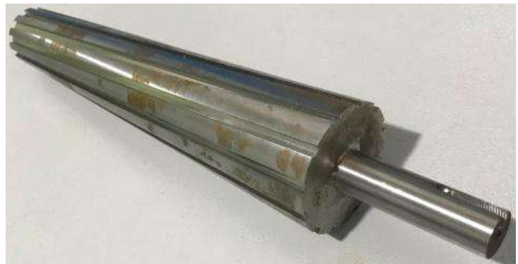
Рисунок 4.2 – Устройства дозирования компонентов: а) шнековый – для непрерывного дозирования, б) роторный – для дискретного дозирования
