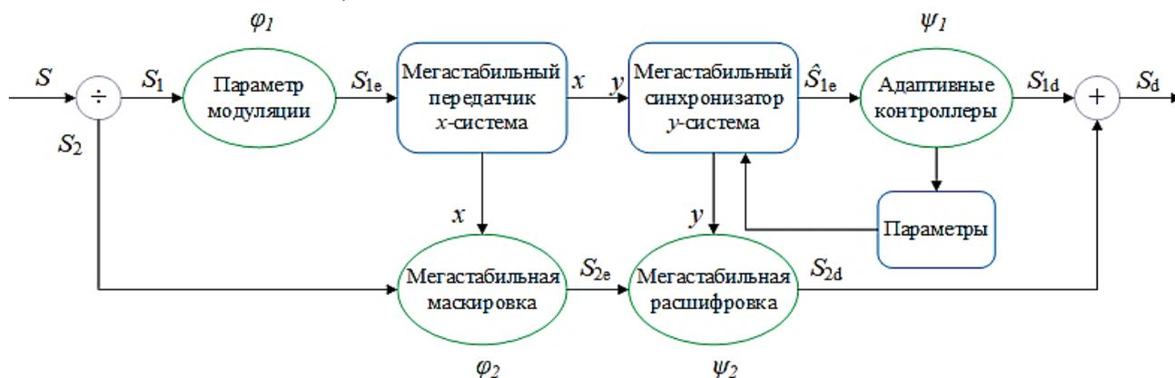
Рис. 11. Хаотическая мегастабильная схема безопасной связи
