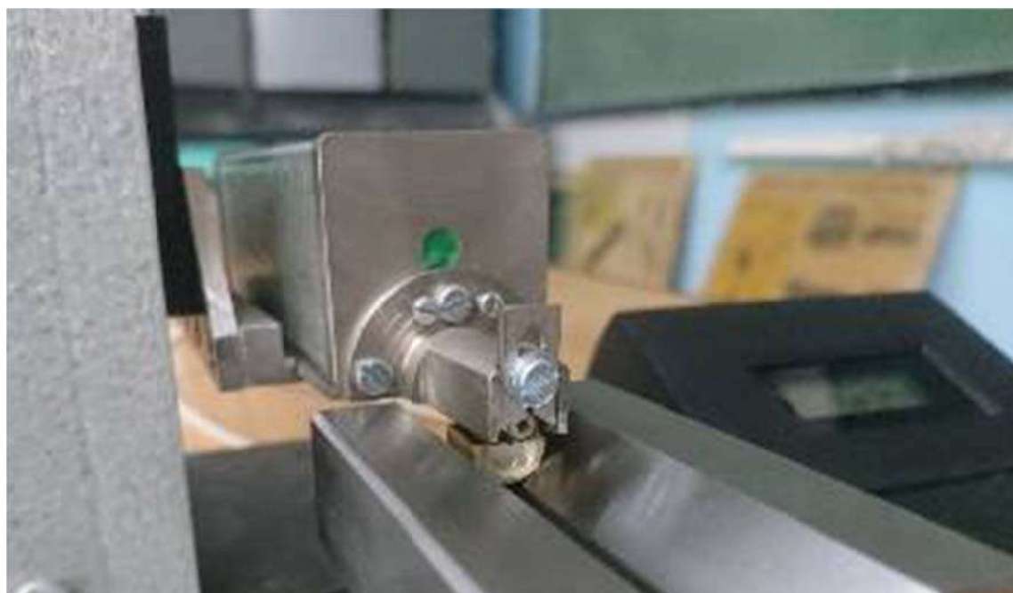
Рис. 4.7. Измерение шероховатости отверстий после сверления цветных металлов и сплавов в ПУДС
