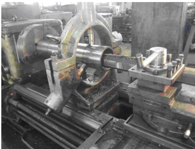
Рисунок 1.12 – Растачивание отверстия трубы на токарном станке 1М63 [28]
