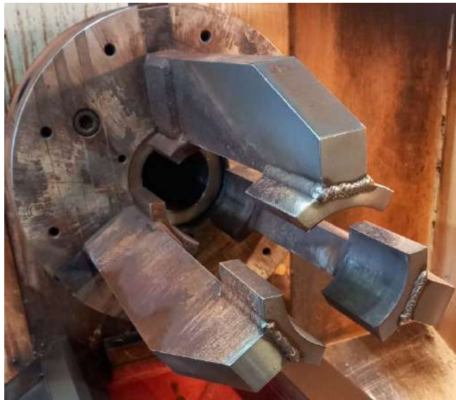
Рисунок 1.10 – Патрон с длинными широкими кулачками с двумя плоскостями центрирования
