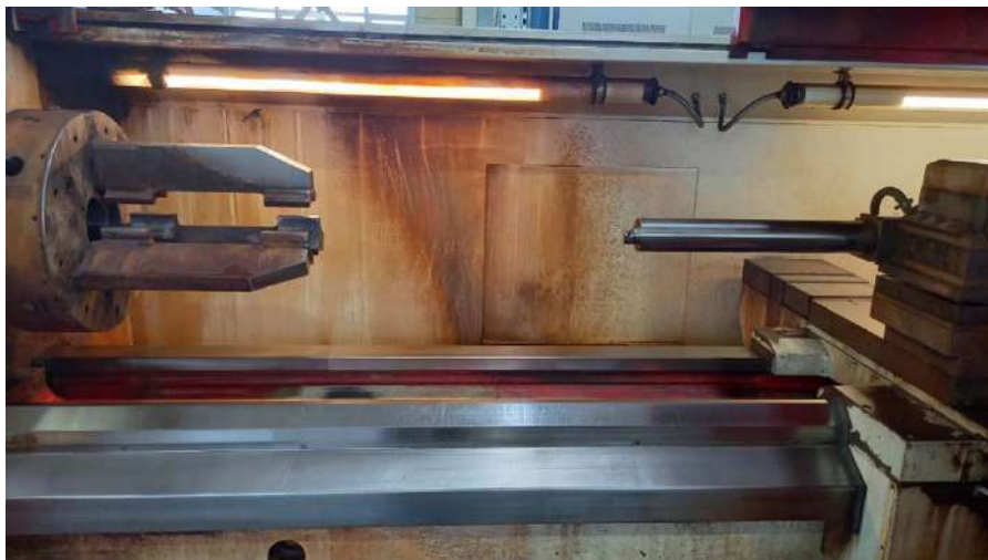
Рисунок 1.11 – Технологическая оснастка для токарной обработки головных и хвостовых труб под закаливание и трехроликовую раскатку
