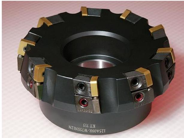
Рис. 5.9 Торцовая фреза с креплением пластины и базирующей подкладки с помощью параллельно установленных клиньев
