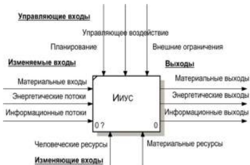
Рис.2.3. Функциональная модель ИИУС
