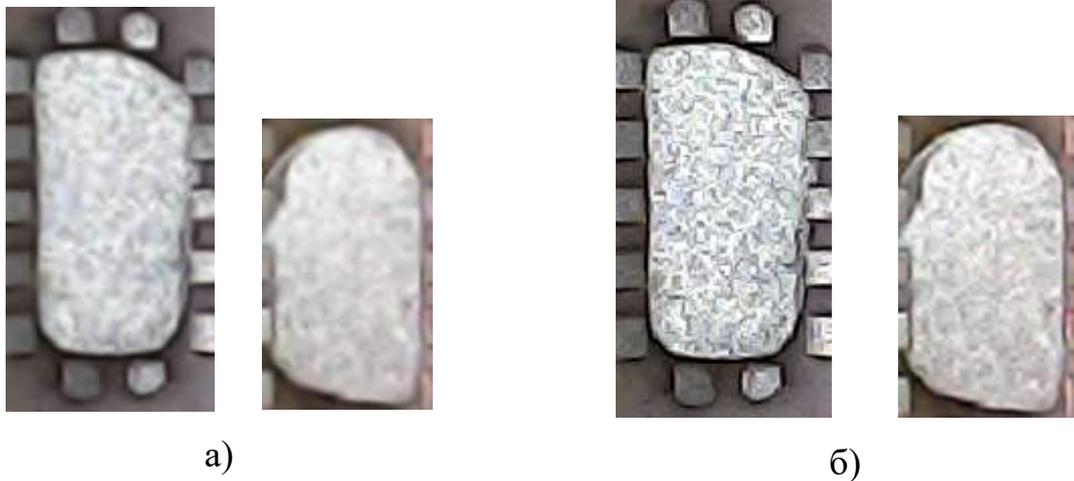
Рис.6.6. Фрагмент изображения с дефектом типа «нависание»
