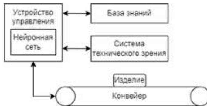
Рис.6.2. Схема технической системы выходного контроля качества
