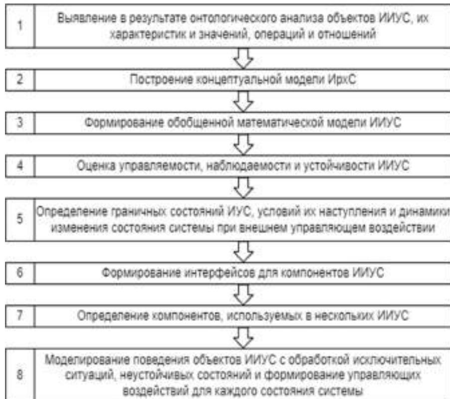
Рис.4.12. Методика построения ИИУС производственным процессом для микро- и нанoeлектроники
