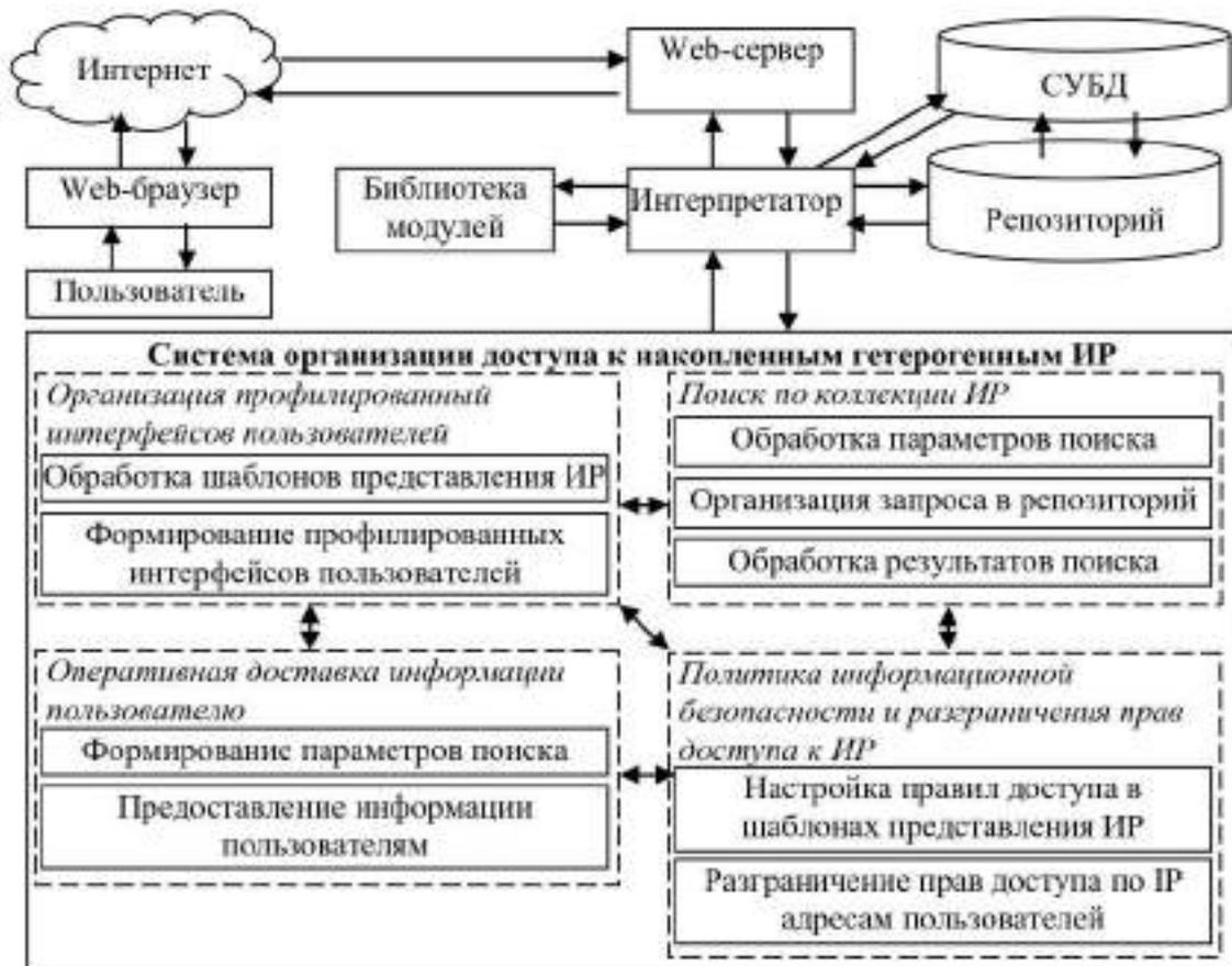
Рис.6.12. Общая схема системы организации доступа к накопленным гетерогенным ИР
