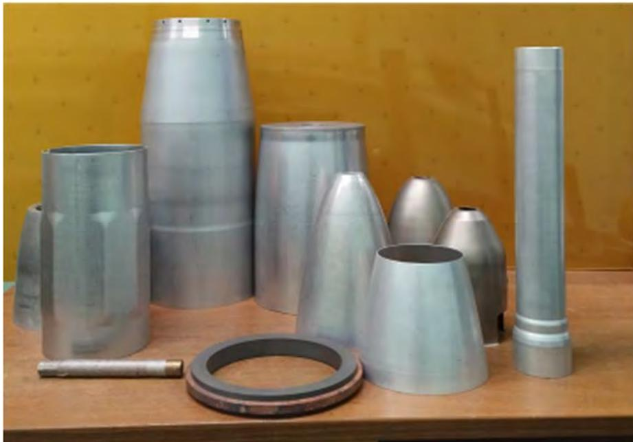
Рисунок 1.2 – Осесимметричные детали, получаемые методом МИОМ
