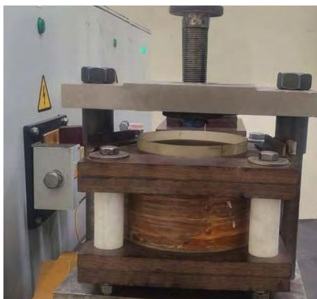
Рисунок 4.22 – Индуктор с механизмом прижима
