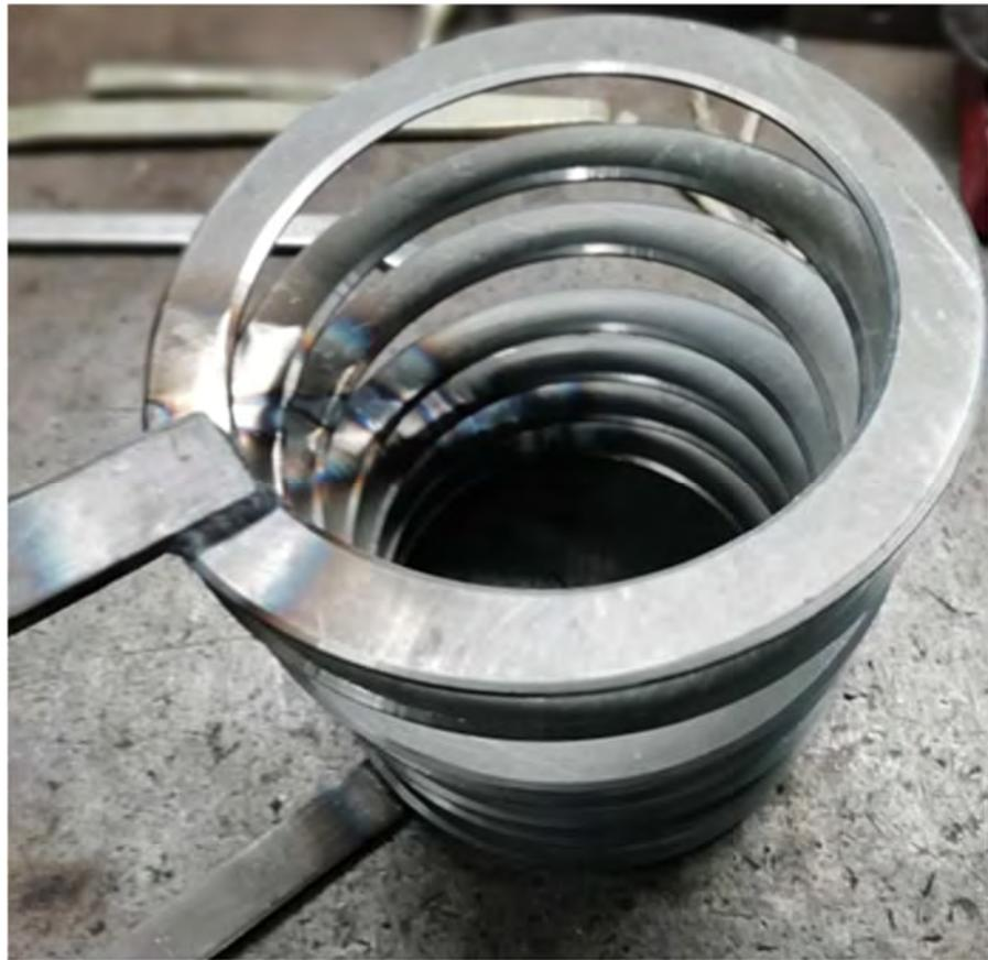
Рисунок 4.34 – Токопровод в сборе
