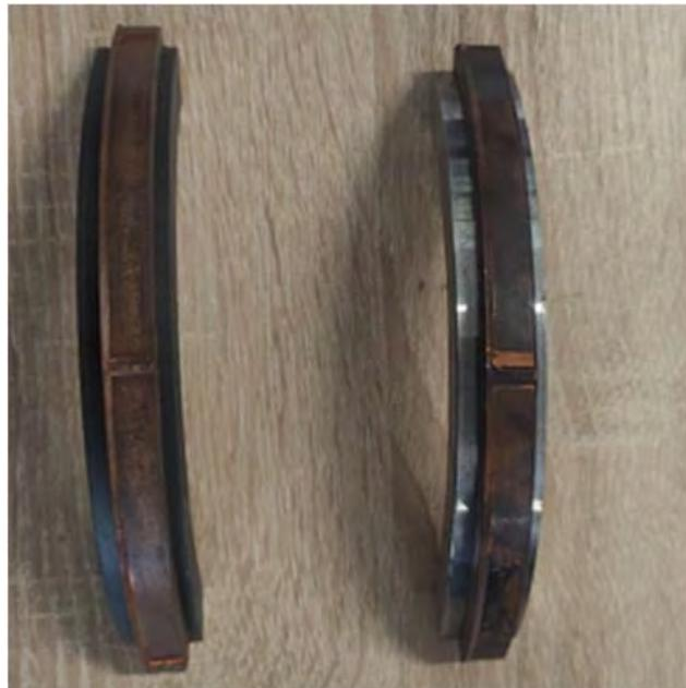
Рисунок 4.20 – Внешние дефекты после запрессовки на гидравлическом прессе
