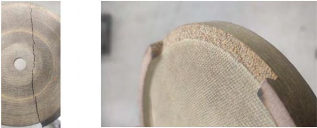
Рисунок 4.24 – Примеры выхода из строя оправки
