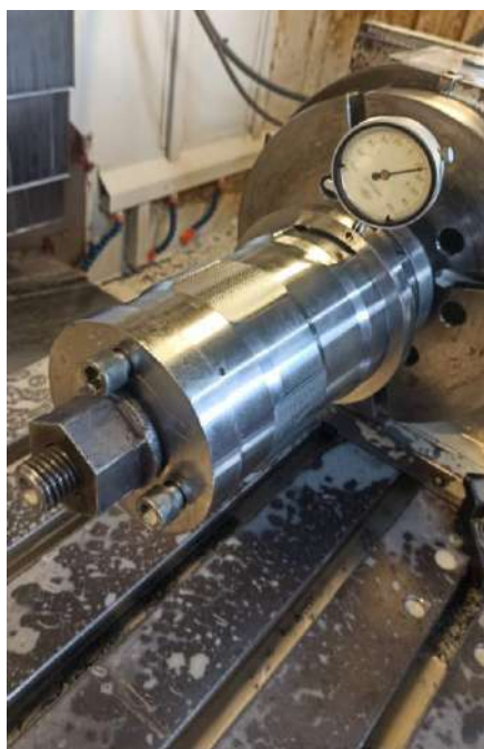
Рисунок 6.6 – Проведение замеров радиусов поверхности впадин втулки, фрезерованной на оправке с упругоэластичной вставкой
