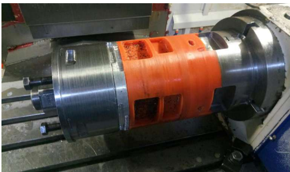
Рисунок 3.29 – Оправка с повышенной виброустойчивостью
