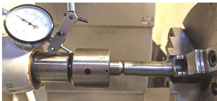
Рисунок 3.22– Экспериментальная установка для определения радиальной деформации стальной втулки при сжатии пакета резиновых шайб осевой нагрузкой
