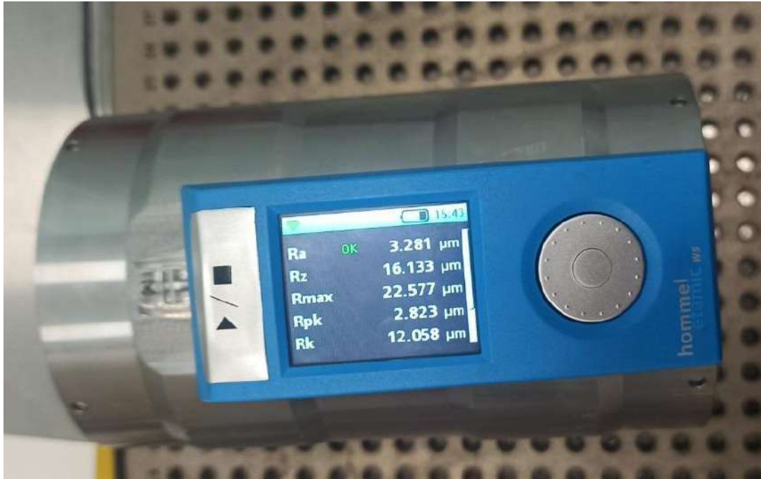
Рисунок 5.9 - Фотография замера шероховатости поверхностей втулки на разработанном приспособлении
