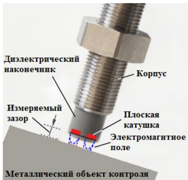
Рисунок 3.11 – Принцип работы проксиметра
