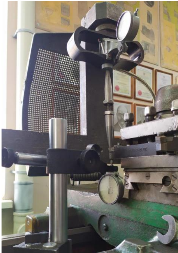
Рисунок 3.9 – Измерение изгиба резца под воздействием силы, имитирующей P_z
