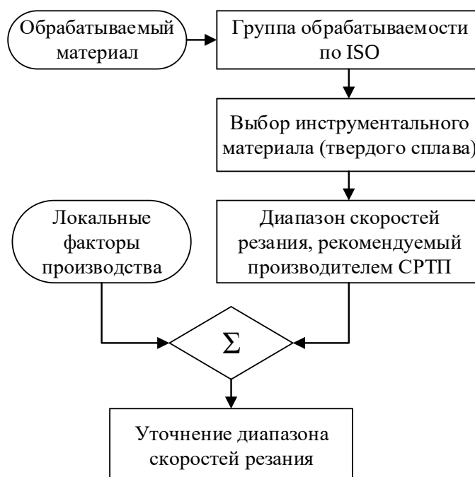
Рисунок 4.3 – Схема выбора инструментального материала и назначения первоначального диапазона скоростей резания
