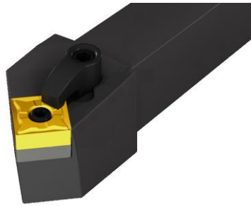
Рисунок 3.2 – Сборный резец с державкой MSSNR 3232 P12 и сменной пластиной по ISO 1832-1991: \gamma = 6^\circ , \gamma_1 = 10^\circ , \alpha = 6^\circ , \alpha_1 = 5^\circ , \varphi = 45^\circ , \varphi_1 = 45^\circ , \lambda = 5^\circ
