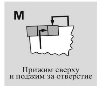
Рисунок 3.3 – Схема механического крепления сменной пластины по ISO
