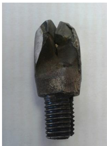
Рисунок 3.5 – Буровой резец с деформированными перьями (стрелками указаны деформированные перья)
