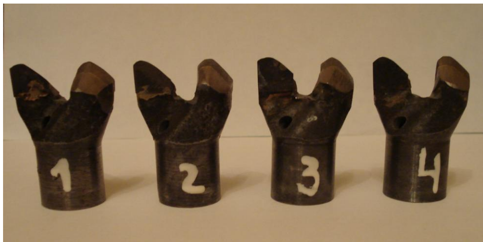
Рисунок 4.2 - Экспериментальные буровые резцы «Кузбас-300» после испытаний
