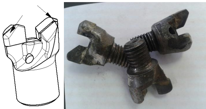
Рисунок 3.1 – Породный буровой резец с затупленными режущими пластинами (стрелками указаны области притупления пластин)
