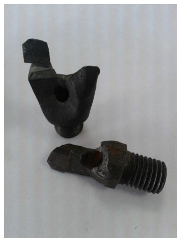
Рисунок 3.4 – Буровой резец с изломом пера (стрелкой указано место излома пера)
