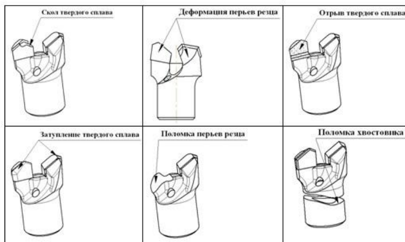
Рисунок 1 – Причины выхода из строя резцов
