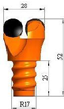
Рисунок 1.11 – Буровой резец РПК-28/R17/13К
