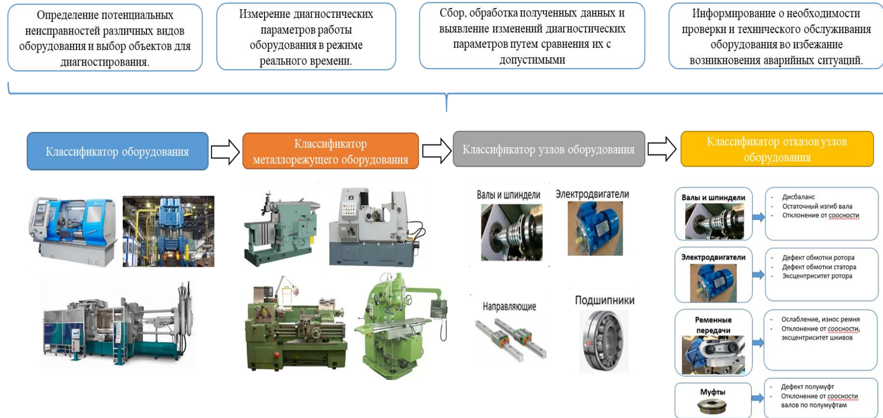
Рисунок 4.10 – Структура сервиса по мониторингу и предиктивной диагностике состояния технологического оборудования
