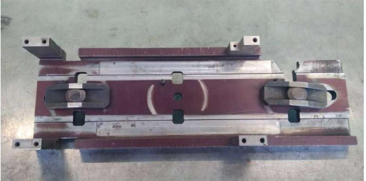
Рисунок 5.5 – Фотография специального приспособления-спутника
