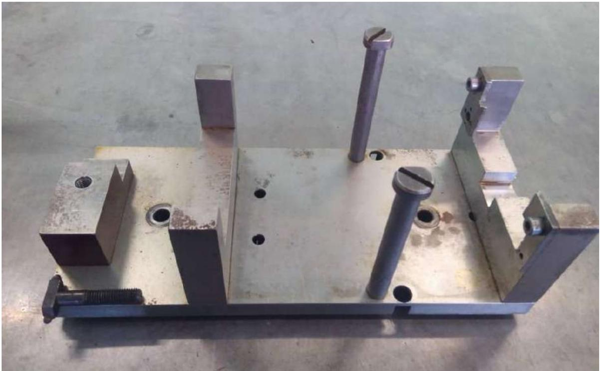
Рисунок 5.9 – Фотография изготовленной базы для установки приспособления-спутника на станке
