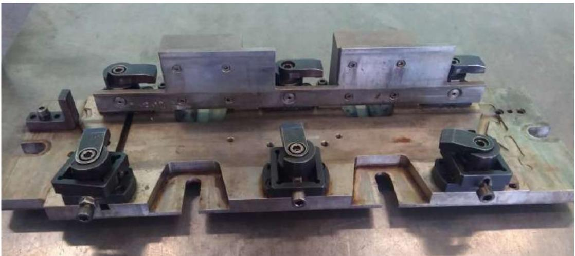
Рисунок 5.2 – Фотография базового приспособления для установки заготовки на станке
