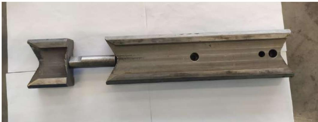
Рисунок 5.3 – Фотография вкладыша для установки заготовки в приспособление на станке
