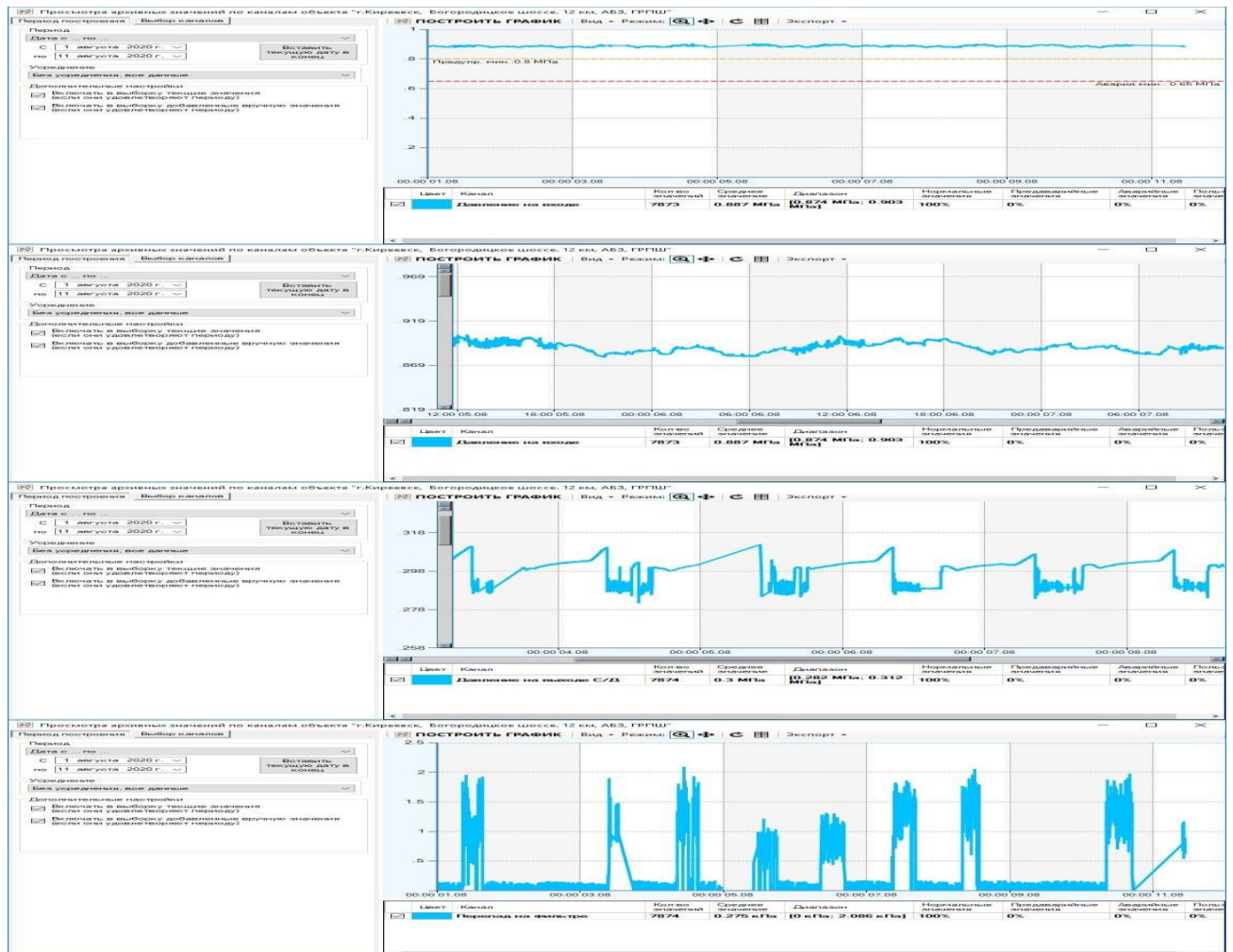
Рисунок 4.8 - Основные показатели ГРПШ на АБЗ г. Киреевска (сверху вниз — вход, амплитуда входа, выход среднего давления, перепад на фильтре).
