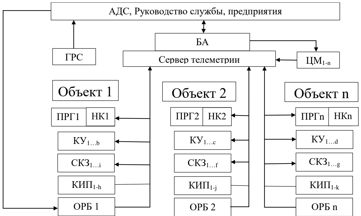
Рисунок 2.3 - Структура информационно-измерительной системы взаимосвязанных объектов газораспределительной сети.
