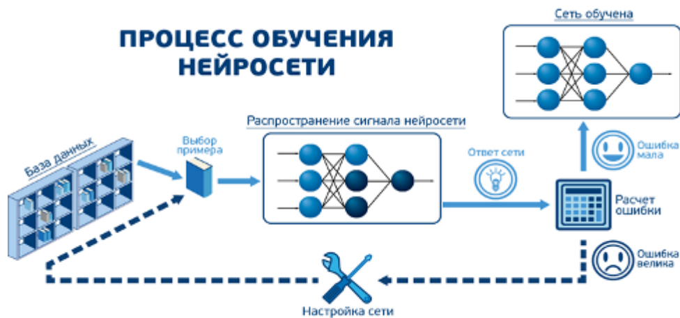
Рисунок 2.12 - Схема обобщенной системы обратного распространения ошибки.
