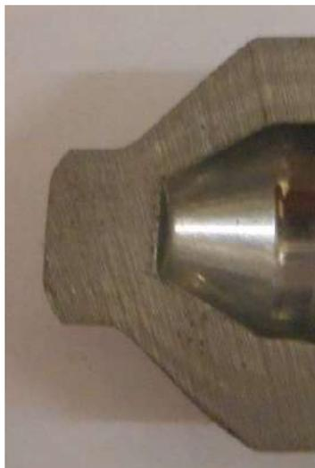
Рисунок 5.2.7 – Внутренняя коническая часть 20-й детали «Корпус» в партии после 3-го технологического перехода
