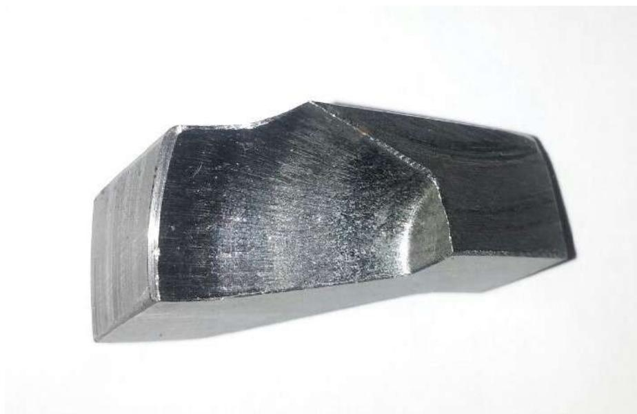
Рисунок 3.1.3.2 – Фрагмент детали «Корпус» с образовавшимся после штамповки браком (20-ая деталь)
