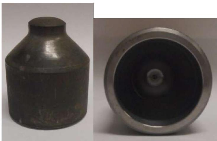
Рисунок 5.3.1 – Деталь «Корпус» после 3-го технологического перехода
