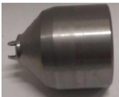
Рисунок 5.3.2 – Деталь «Корпус» после обработки резанием
