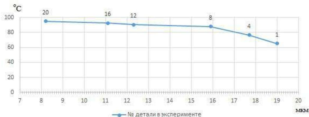
Рисунок 2.1.4 – Диаграмма зависимости толщины технологического покрытия от температуры
