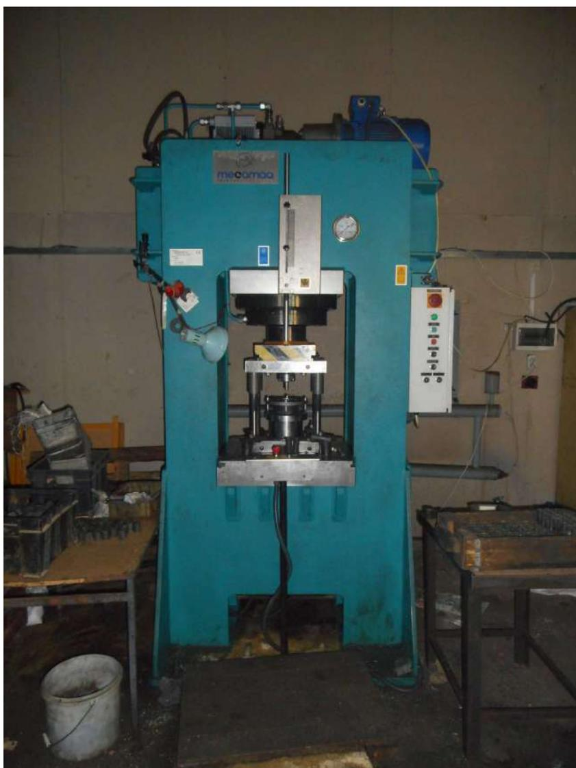
Рисунок 3.1.2.5 – Гидравлический пресс модели ДО138Б
