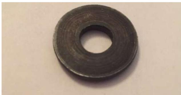
Рисунок 2.2.2.2 – Кольцевой образец после осадки.
