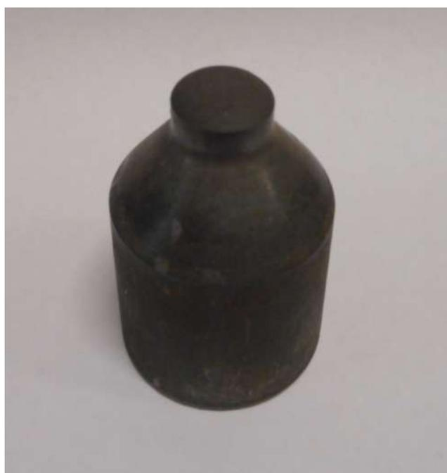
Рисунок 3.1.2.4 – Фото детали после выдавливания
