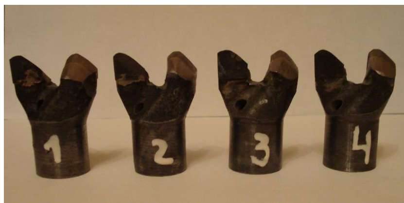
Рисунок 9 – Экспериментальные буровые резцы «Кузбас-300» после проведения испытаний
