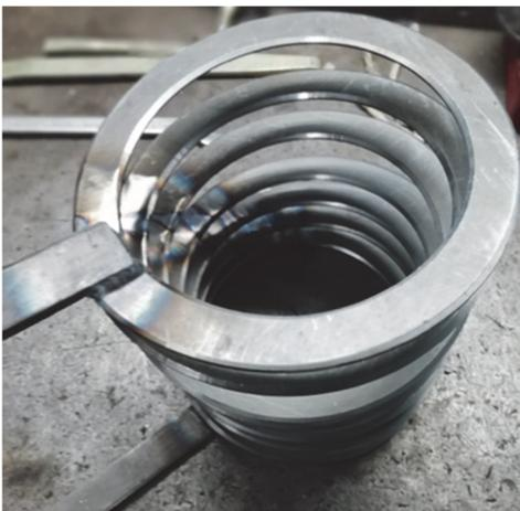
**Рисунок 7 – Токопровод в сборе**
