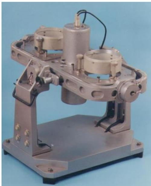
Рис. 1.2.18. Гиростабилизатор комплекса «ГРИН»
