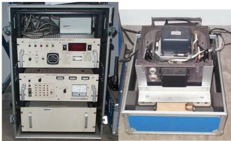
Рис.1.2.16. Гиросtabilизированный гравиметр BGM-3 фирмы BELL Aerospace
