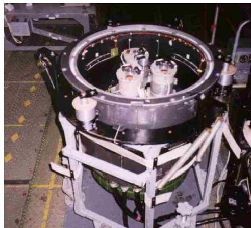
Рис.1.2.14. Аэрогравиметрический комплекс «Гравитон - М»
