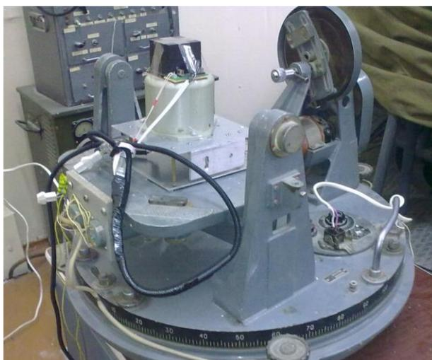
Рис.4.7.2. Система ориентации на испытательном стенде
