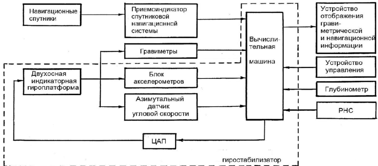
Рис.1.2.7. Функциональная схема информационно - измерительной системы ГРИН-2000
