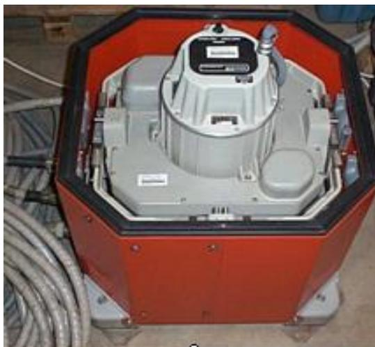
Рис.1.2.15. Гиросtabilизированный гравиметр KSS 31 фирмы BODENSEEWORK
