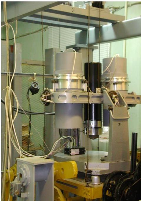
Рис.1.2.22. Комплекс «ГРИН» на стенде вертикальных перемещений (применены гравиметры ГМН с двойным контуром термостатирования)
