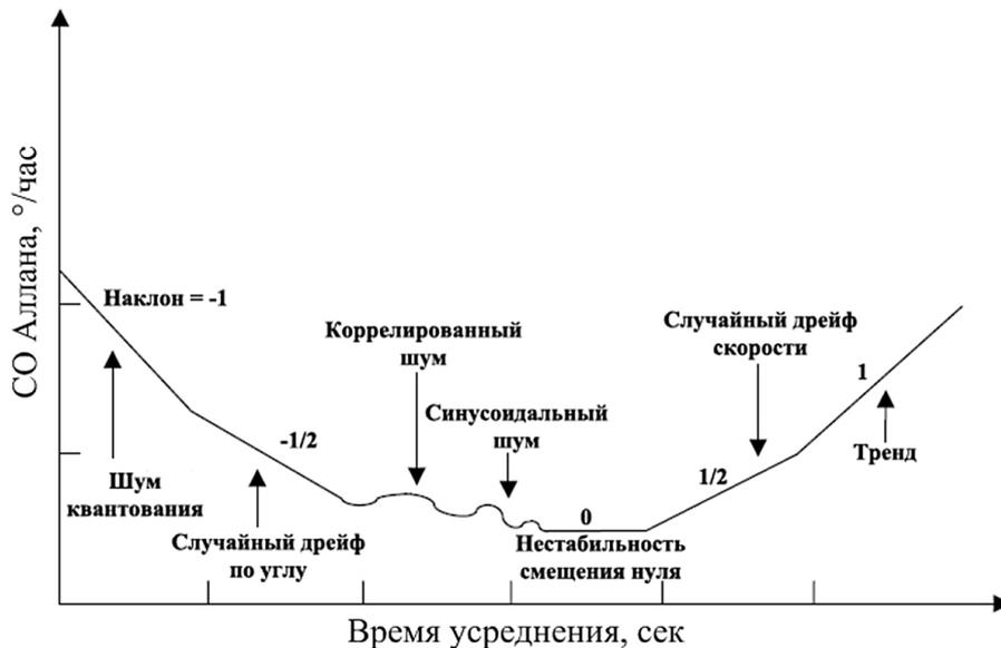
Рисунок 5.2.1. График стандартного отклонения Аллана
