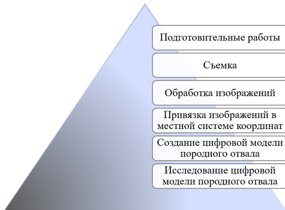
Рисунок 2.41 – Стадии создания цифровой модели породного отвала с использованием БПЛА
