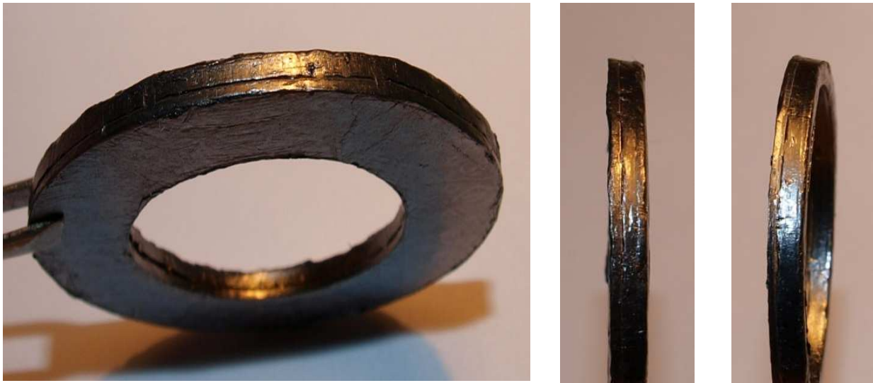
Рис. 5. Дефекты трехслойных изготавливаемых деталей: слева - деформация среднего слоя и заусенец на торцевой поверхности; справа - те же дефекты и неперпендикулярность торца и плоскостей детали
