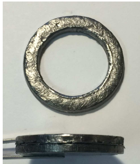
Рис. 7. Образцы уплотнителя и отхода пробивки, полученные инструментом с рациональными размерами клиньев
