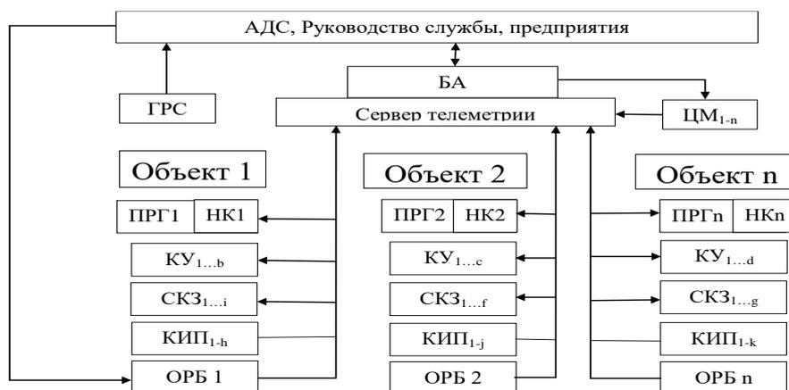
Где  $n, b, e, d, l, f, g, h, j, k$  количество взаимосвязанных объектов, КУ-крановые узлы, СКЗ – станции катодной защиты, КИП – контрольно-измерительные пункты в каждом взаимосвязанном объекте, соответственно.
