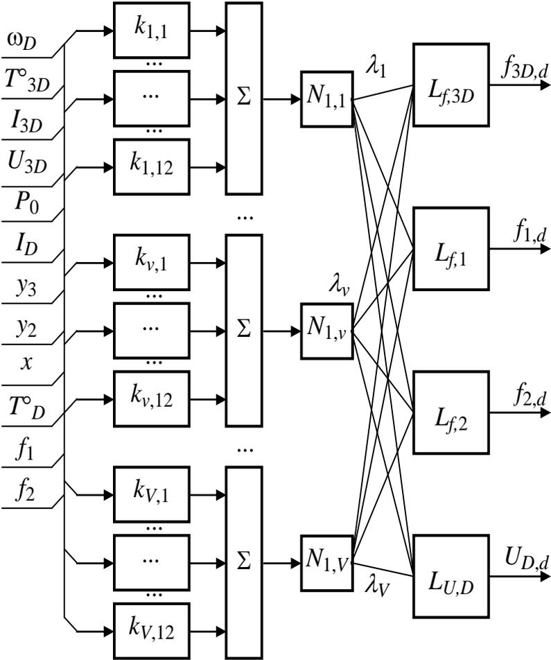
Рис. 4.4. Система управления буровым агрегатом нейронным регулятором.
