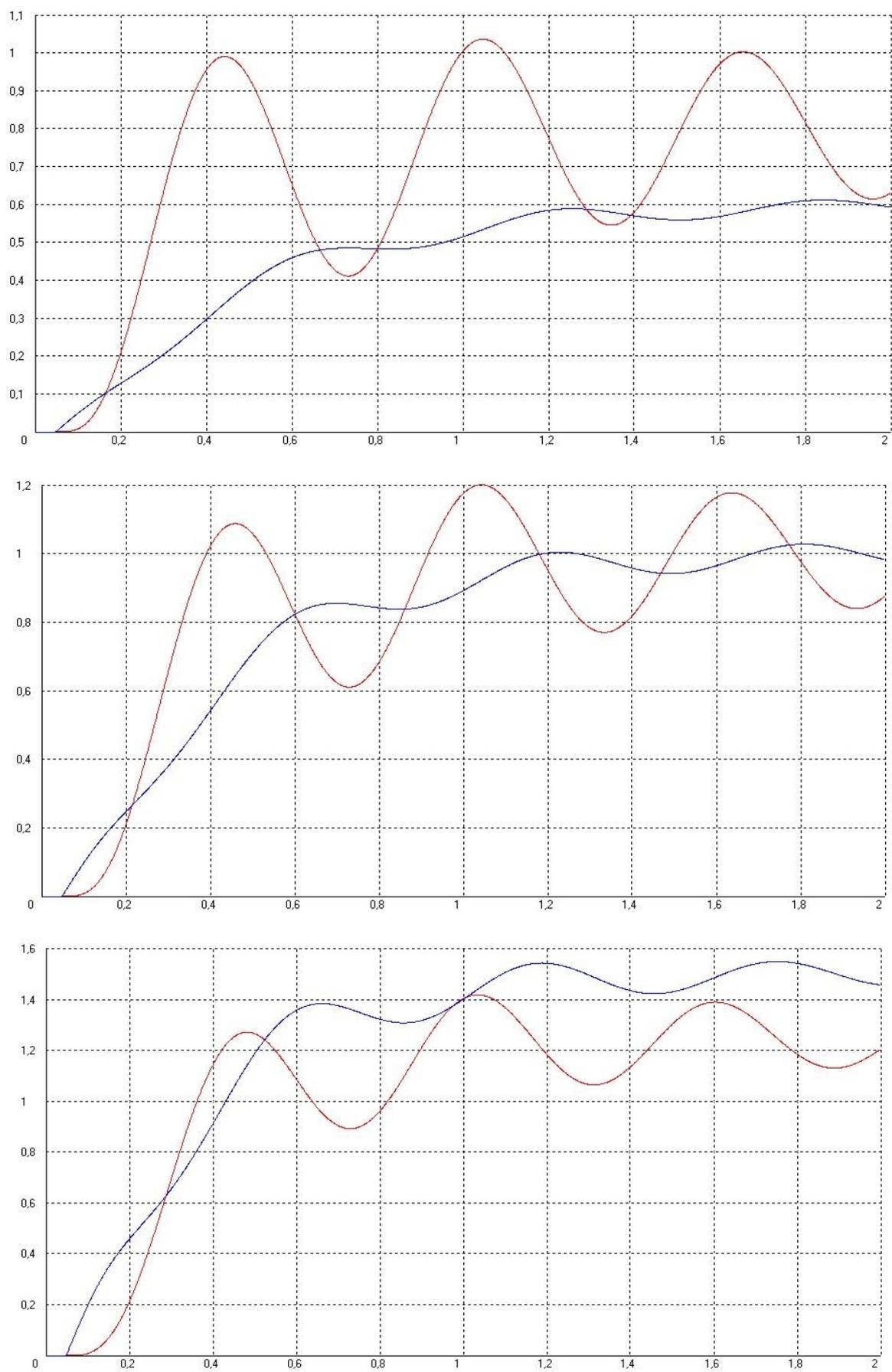
Рис. 4.13. Система обратная связь, время задержки  $t=0,05$  коэффициент передачи полиспаста  $k=1$ , коэффициент передачи бура: а)  $k=0,5$ ; б)  $k=1$ ; в)  $k=2$
