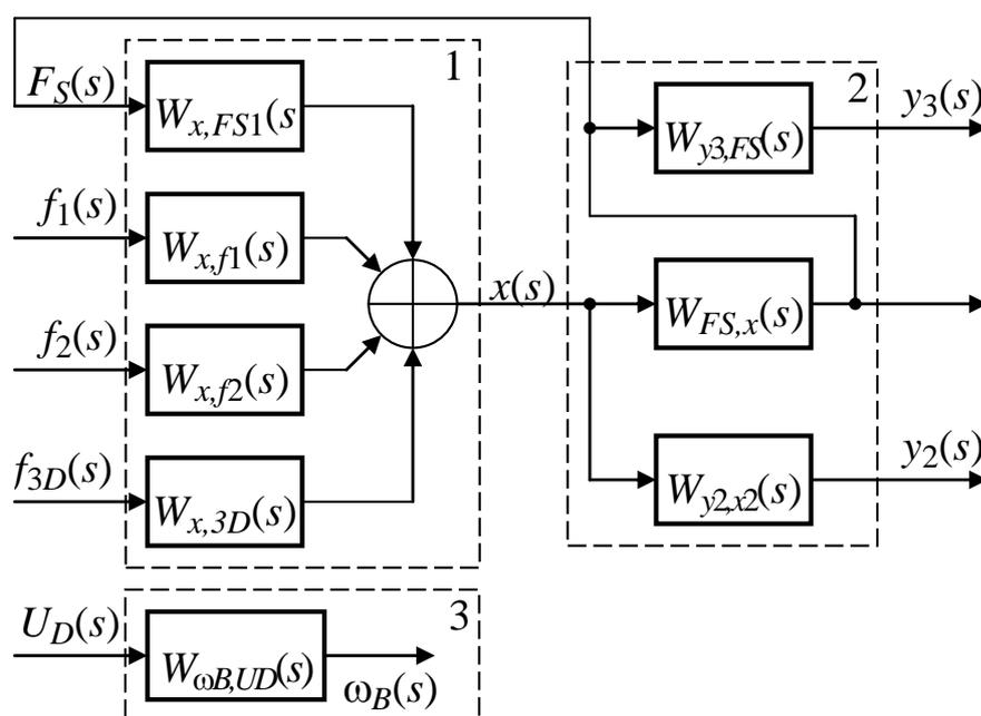
Рис. 3.3. Структурная схема бурового агрегата СБШ-250МН-32Т как объекта управления, функционирующего в режиме поднятия/опускания бура: 1 - модель гидравлической трансмиссии; 2 - модель полиспаста; 3 - модель вращателя;
