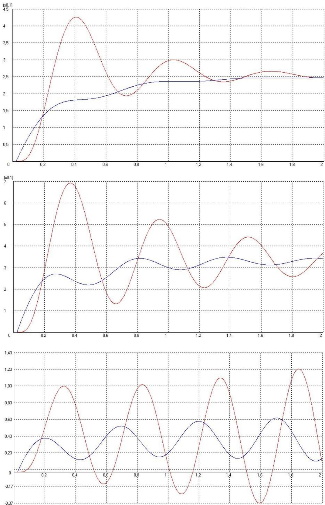
Рис. 4.16. Система обратная связь (положительная), время задержки  $t=0,025$  с:
