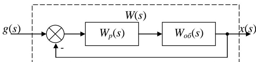
Рис. 1.16. Типовая схема включения ПИД-регулятора в контур обратной связи
