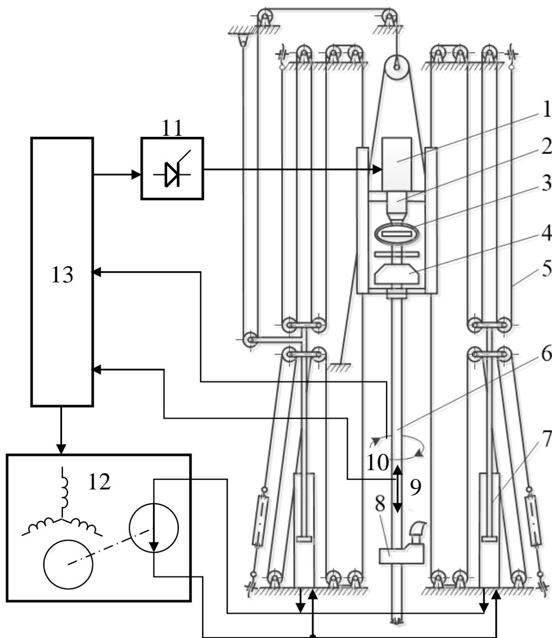
Рис.1.13. Функциональная схема системы управления буровым агрегатом СБШ-250-МН-32Т
