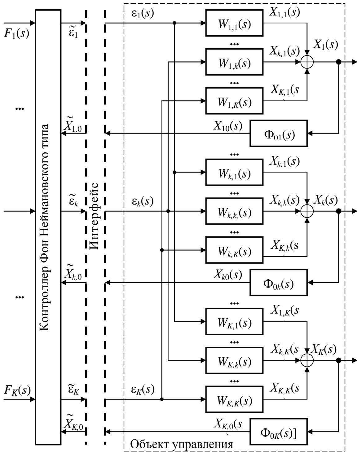
Рис. 3.4. Обобщенная структурная схема цифровой системы управления многоконтурными объектами.
