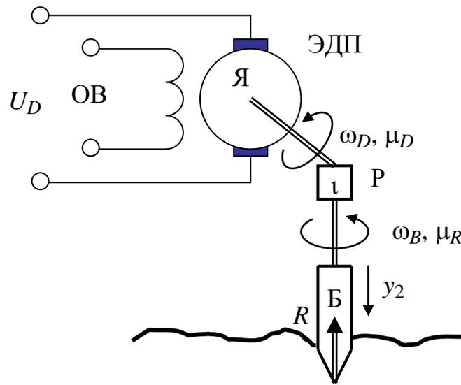
Рис. 2.6. Схема электродвигателя постоянного тока
