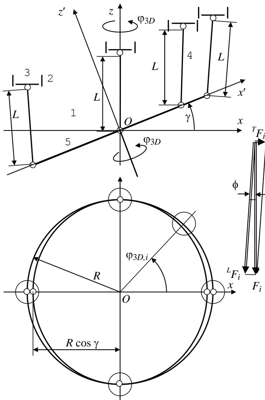
Рис. 2.3. Формирование сил, создающих момент на валу гидронасоса
