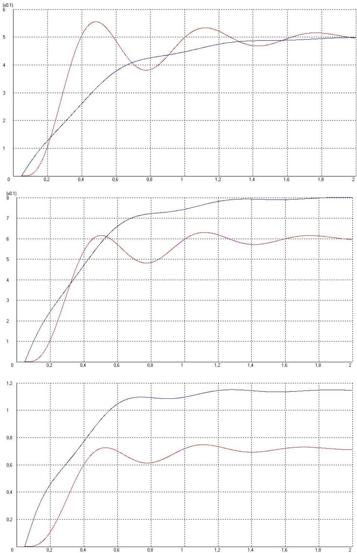
Рис. 4.12. Система обратная связь, время задержки  $t=0,05$  коэффициент передачи полиспаста  $k=0,5$ , коэффициент передачи бура: а)  $k=0,5$ ; б)  $k=1$ ; в)  $k=2$
