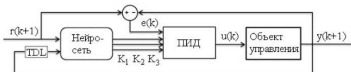
Рис. 1.19. Схема гибридного нейро-ПИД управления [103]
