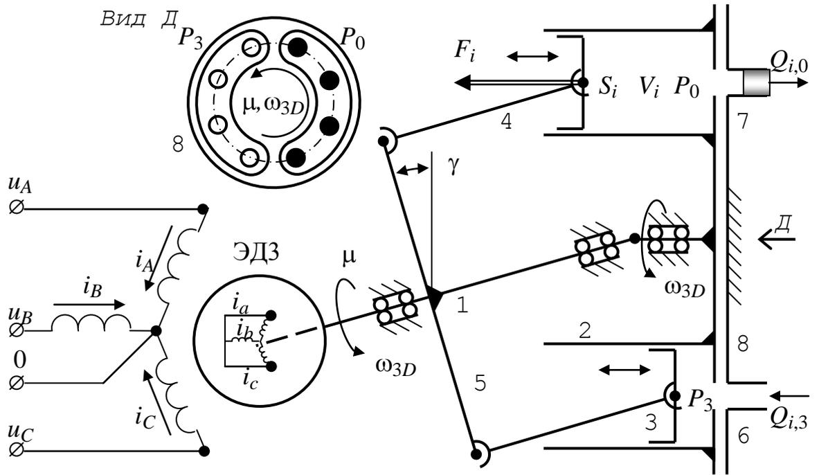
Рис. 2.2. Функциональная схема гидронасоса с электродвигателем
