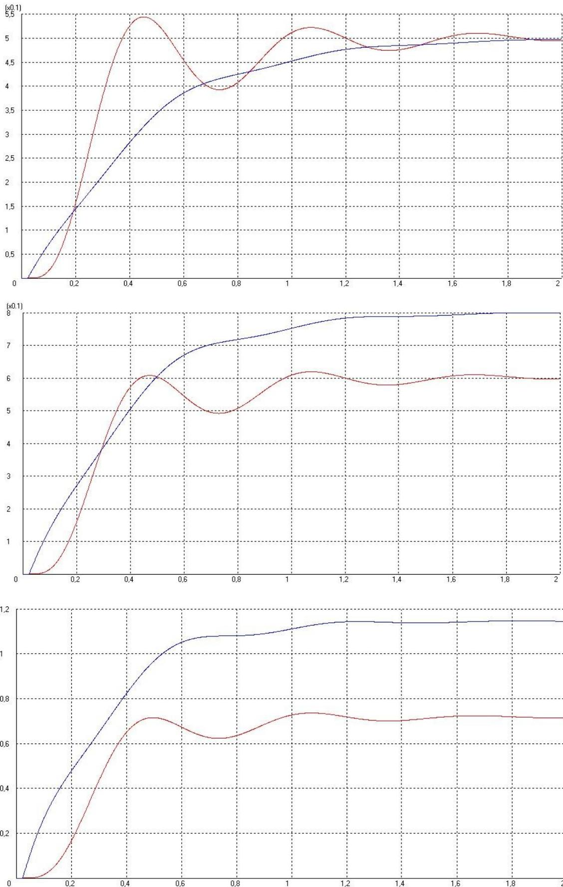
Рис. 4.9. Система обратная связь, время задержки  $t=0,025$  коэффициент передачи полиспаста  $k=0,5$ , коэффициент передачи бура: а)  $k=0,5$ ; б)  $k=1$ ; в)  $k=2$
