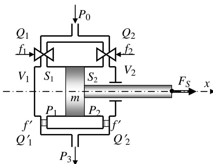
Рис. 2.5. Линейный гидравлический привод двустороннего действия
