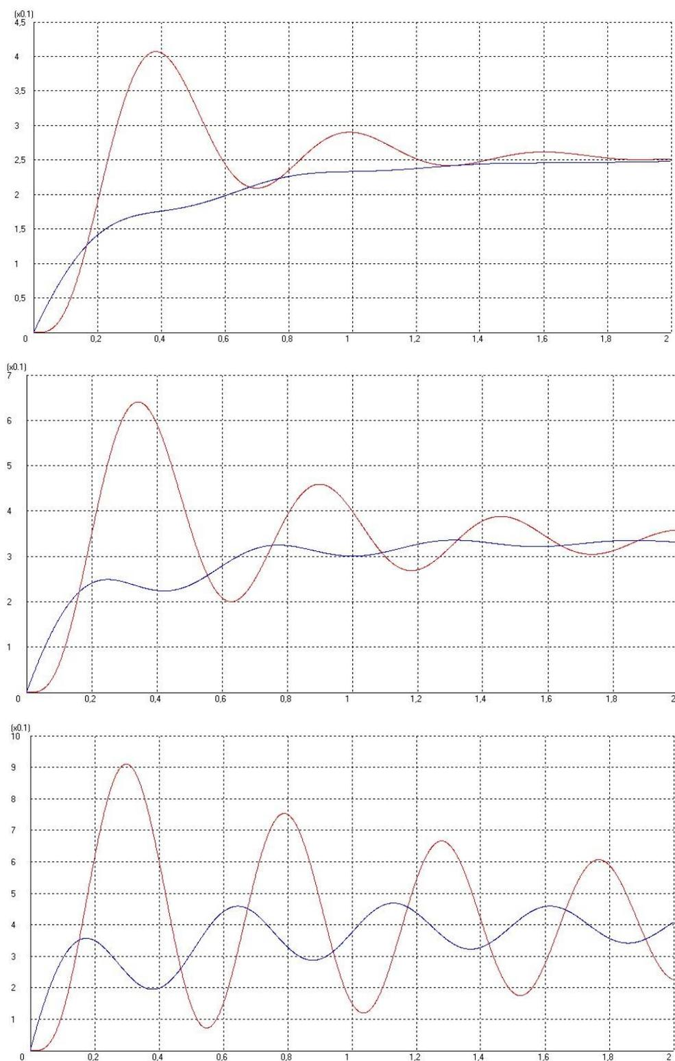
Рис. 4.15. Система обратная связь (положительная), время задержки  $t=0$  с:
