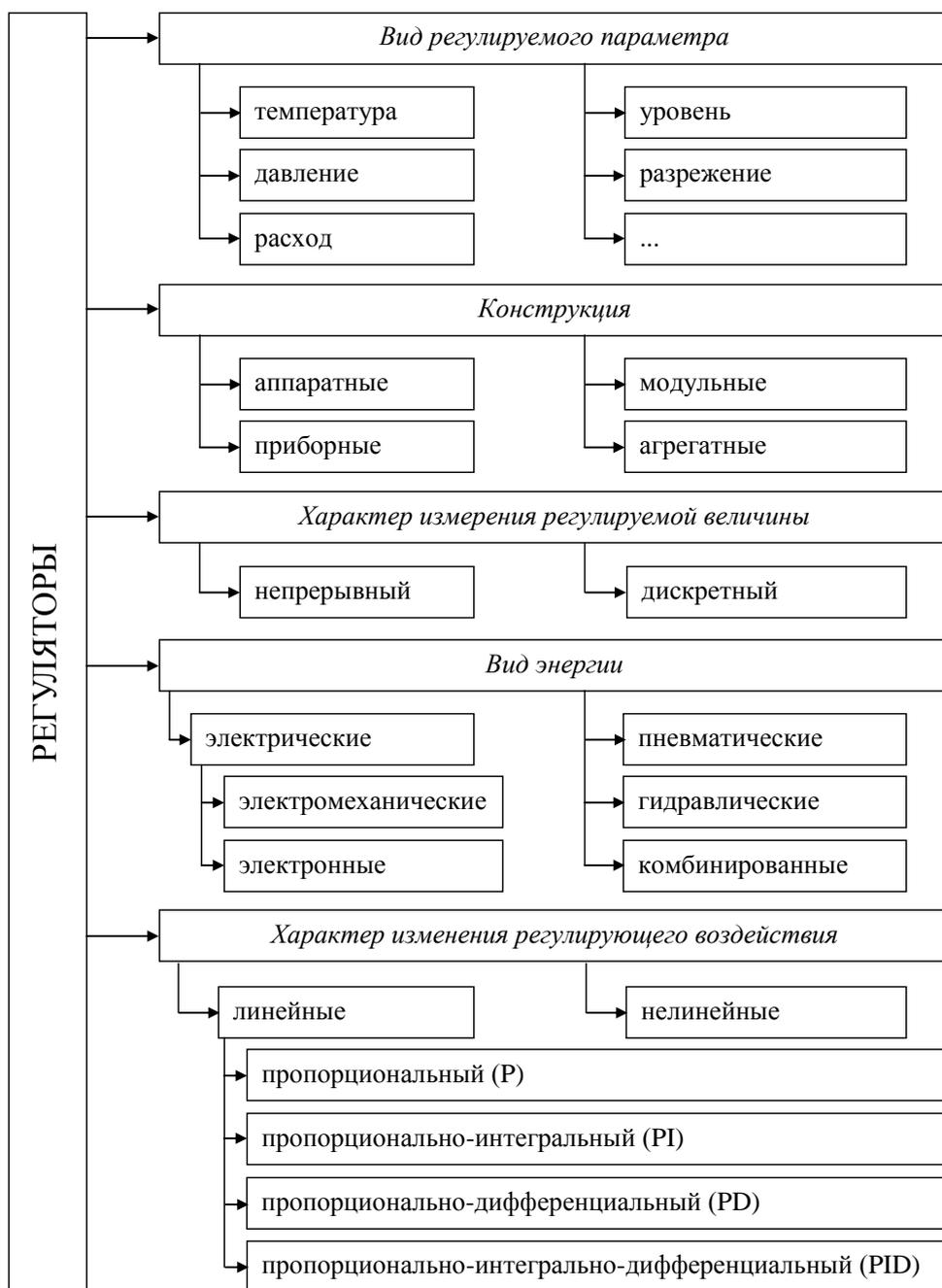
Рис. 1.17. Классификация линейных автоматических регуляторов
