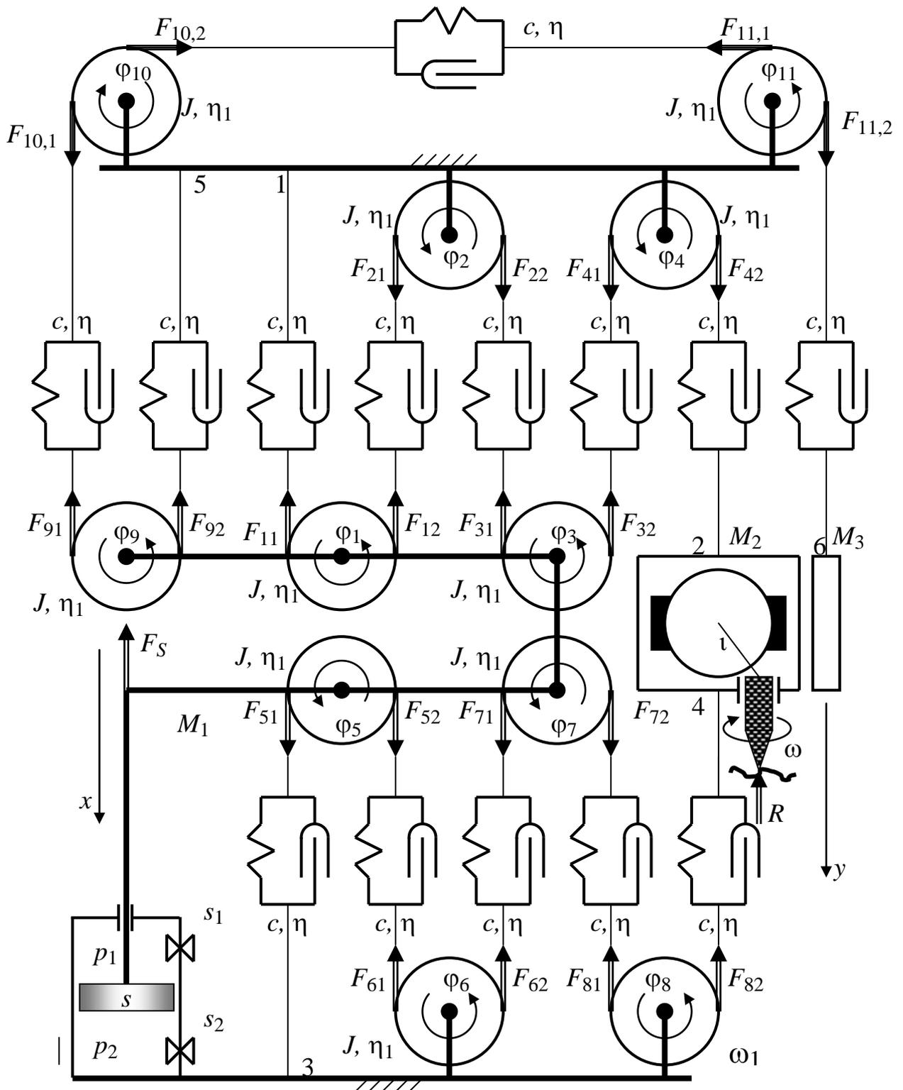
Рис. 2.1. Кинематическая схема полиспастной системы
