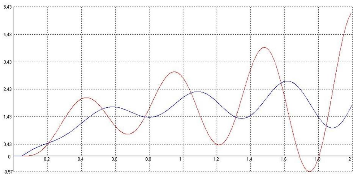
Рис. 4.14. Система обратная связь, время задержки  $t=0,05$  коэффициент передачи полиспада  $k=2$ , коэффициент передачи бура: а)  $k=0,5$ ; б)  $k=1$ ; в)  $k=2$
