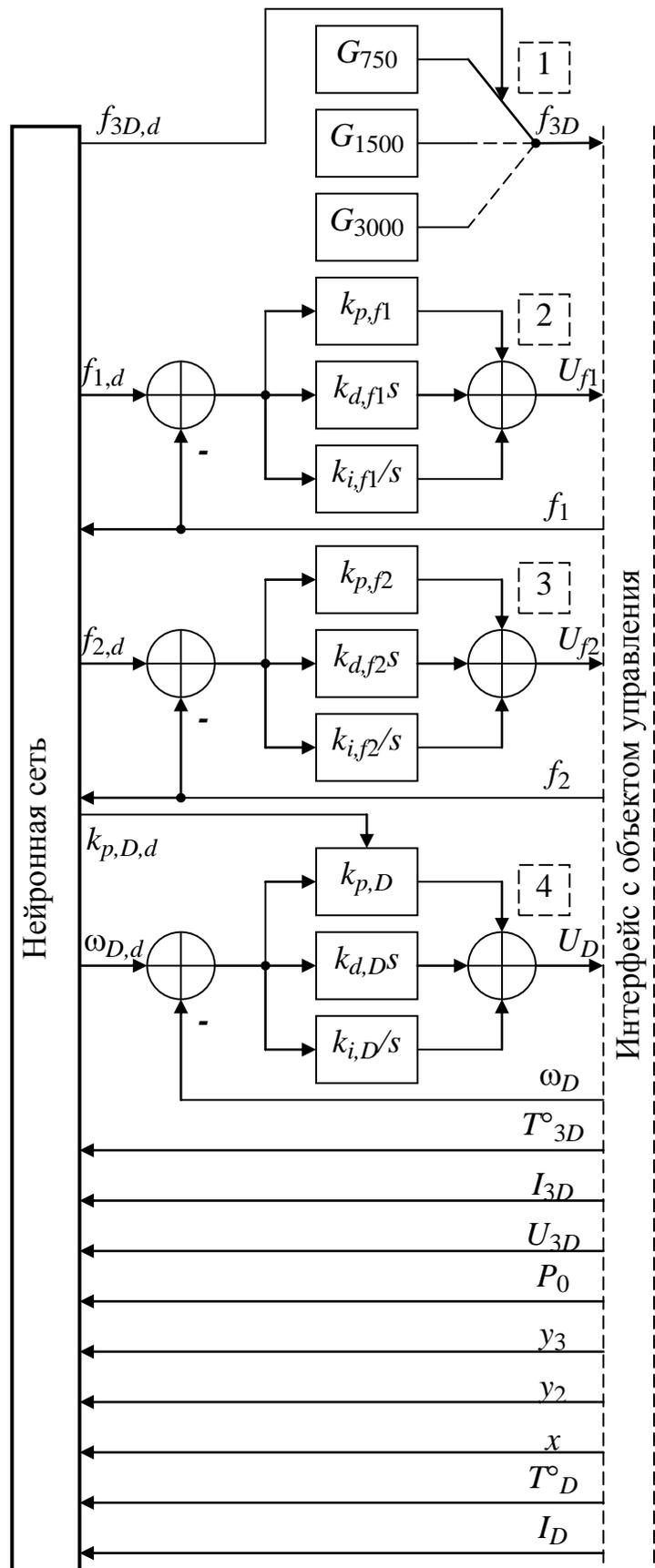
Рис. 4.2. Цифровой контроллер с нейронной сетью
