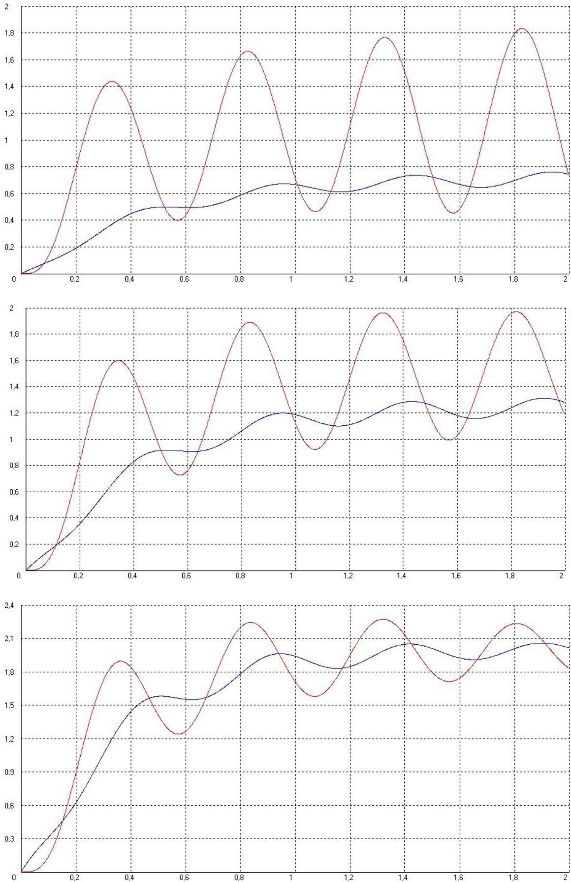
Рис. 4.8. Система обратная связь, время задержки  $t=0$  коэффициент передачи полиспаста  $k=2$ , коэффициент передачи бура: а)  $k=0,5$ ; б)  $k=1$ ; в)  $k=2$
