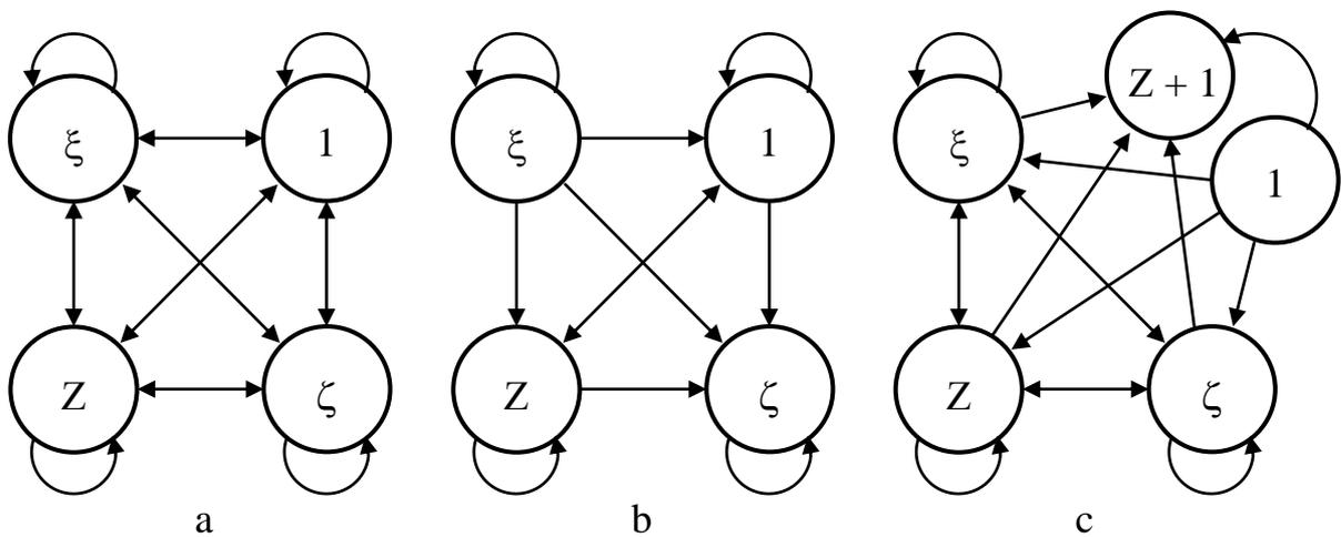
Рис. 3.6. Структура полумарковского процесса: а - исходная; б - для оценки временного интервала между транзакциями; в - для оценки времени возврата в начало цикла
