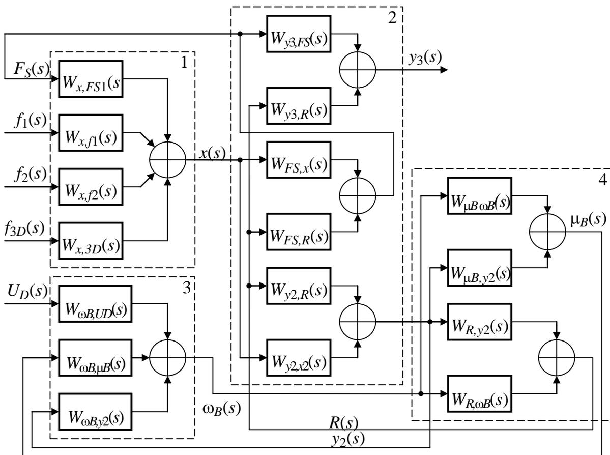
Рис. 3.2. Структурная схема бурового агрегата СБШ-250МН-32Т как объекта управления, функционирующего в режиме бурения:
