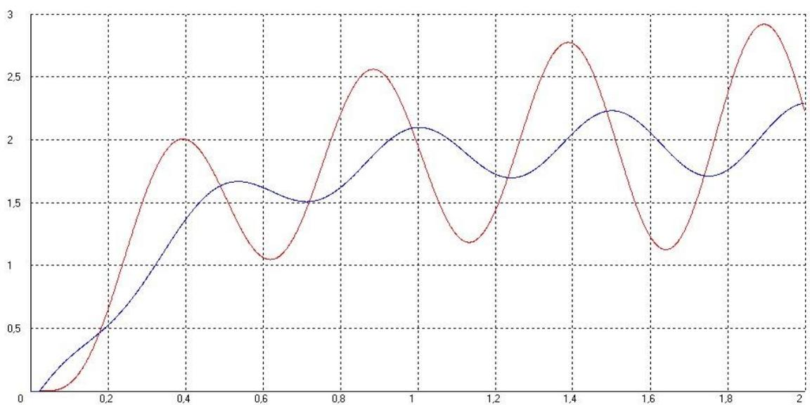
Рис. 4.11. Система обратная связь, время задержки  $t=0,025$  коэффициент передачи полиспаста  $k=2$ , коэффициент передачи бура: а)  $k=0,5$ ; б)  $k=1$ ; в)  $k=2$
