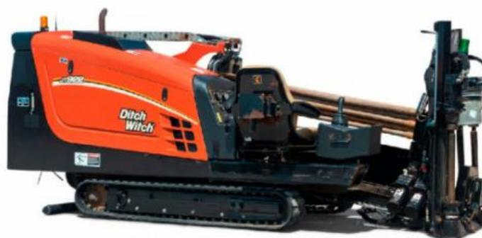
Рис. 1.2. Установка ГНБ Ditch Witch JT922
