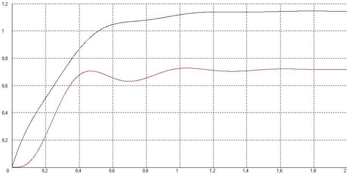
Рис. 4.6. Система обратная связь, время задержки  $t=0$  коэффициент передачи полиспафта  $k=0,5$ , коэффициент передачи бура: а)  $k=0,5$ ; б)  $k=1$ ; в)  $k=2$
