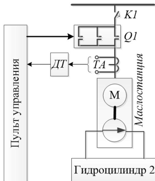
Рис. 1.15. Схема системы управления подачей бура
