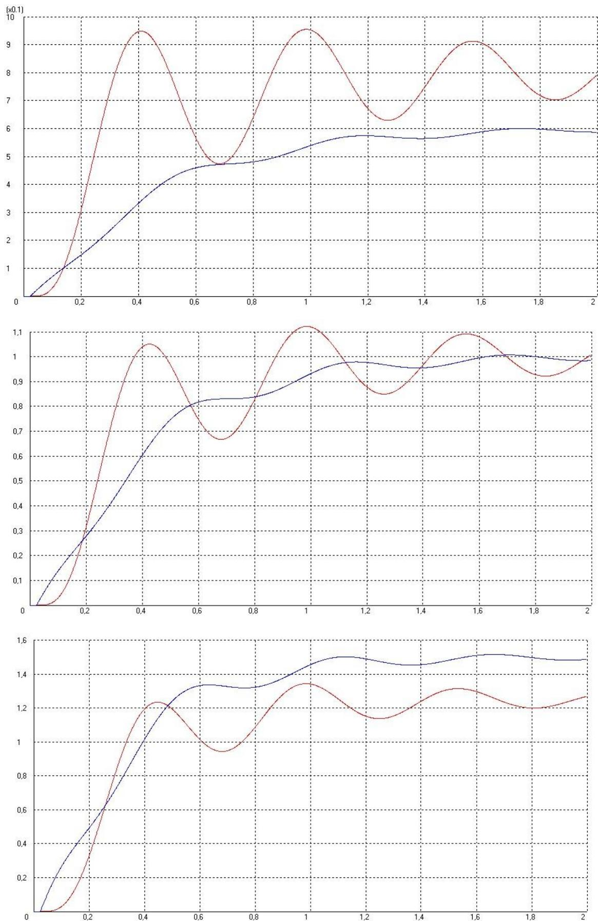
Рис. 4.10. Система обратная связь, время задержки  $t=0,025$  коэффициент передачи полиспаста  $k=1$ , коэффициент передачи бура: а)  $k=0,5$ ; б)  $k=1$ ; в)  $k=2$
