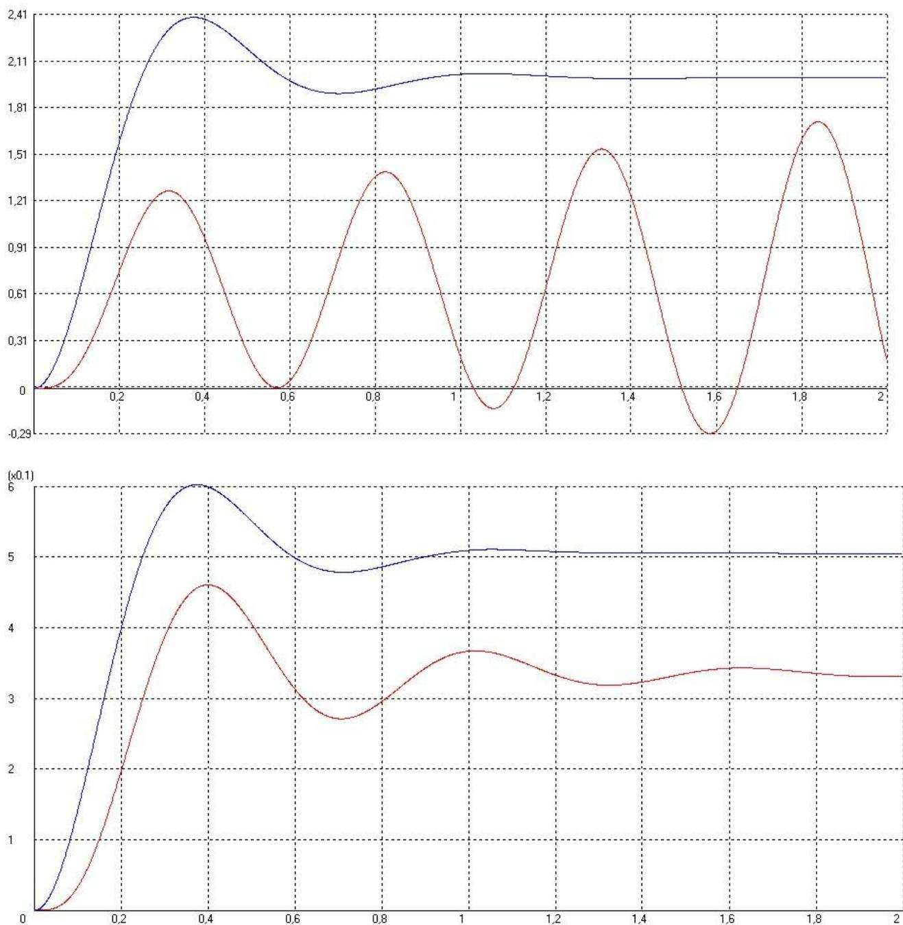
Рис. 4.5. Система полиспа-бур и бур коэффициент передачи полиспа  $k=1$ , коэффициент передачи бура: а)  $k=1$ ; б)  $k=2$ ; в)  $k=0,5$
