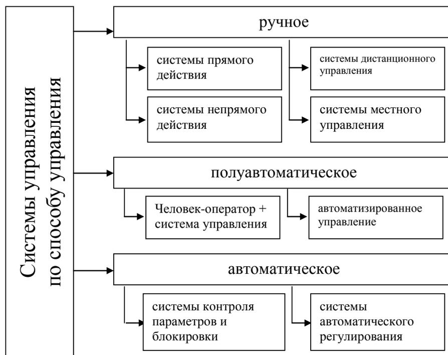
Рис. 1.11. Классификация систем управления буровыми агрегатами
