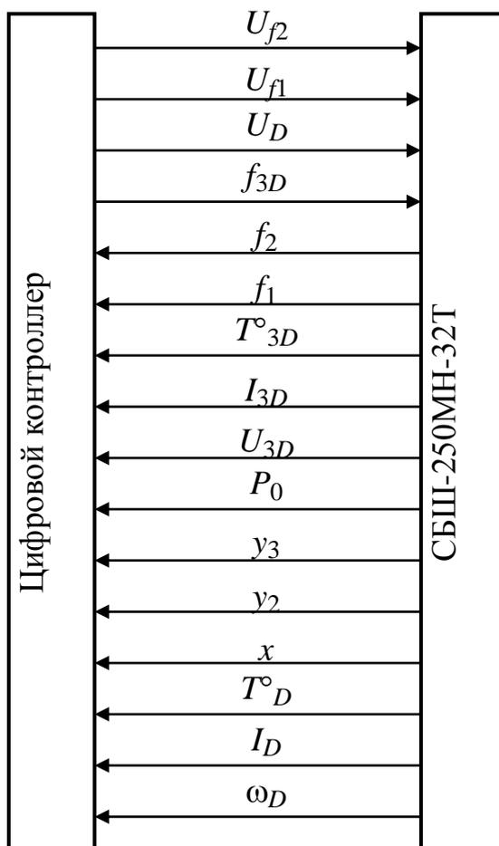
4.1. Структурная схема регулятора
