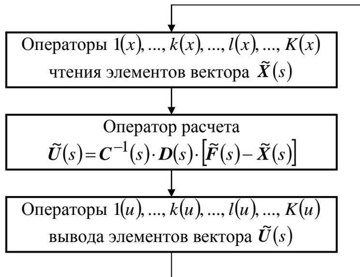
Рис. 3.8. Структура простейшего управляющего алгоритма
