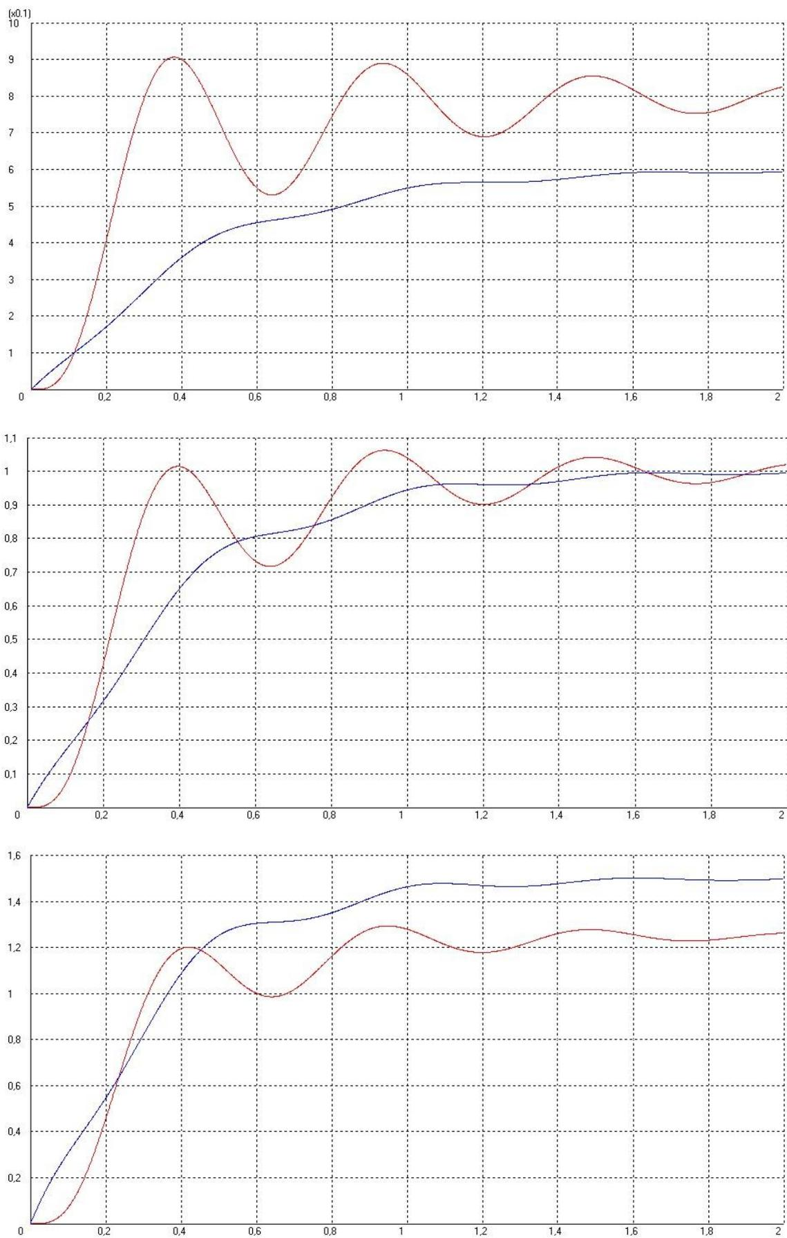
Рис. 4.7. Система обратная связь, время задержки  $t=0$  коэффициент передачи полиспаста  $k=1$ , коэффициент передачи бура: а)  $k=0,5$ ; б)  $k=1$ ; в)  $k=2$
