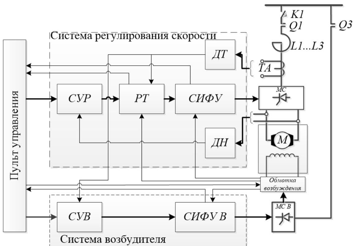
Рис. 1.14. Функциональная схема системы управления двигателем вращения бура
