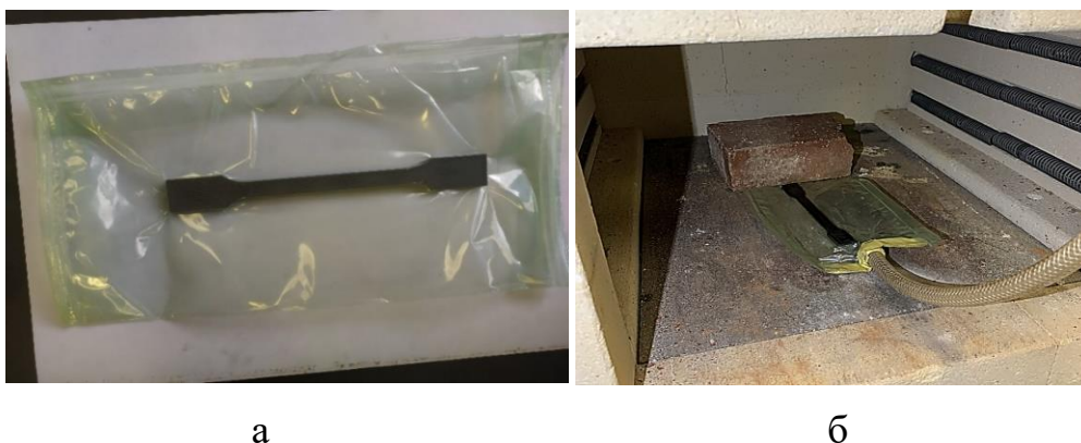
Рисунок 76 – Термическая постобработка в вакуумном пакете, где: а – без включенного насоса; б – с включенным насосом
