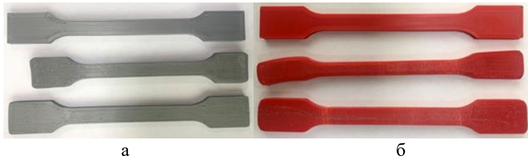
Рисунок 88 – Деформации образцов после постобработки (сверху вниз – контрольный образец, образец после обработки в NaCl, образец после обработки в форме с давлением): а – угол наклона растра 0°; б – угол наклона растра 90°
