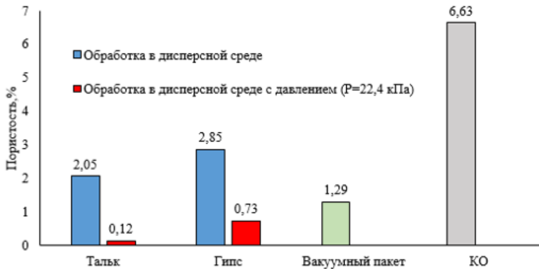
Рисунок 82 – Пористость образцов после термической постобработки с давлением и без
