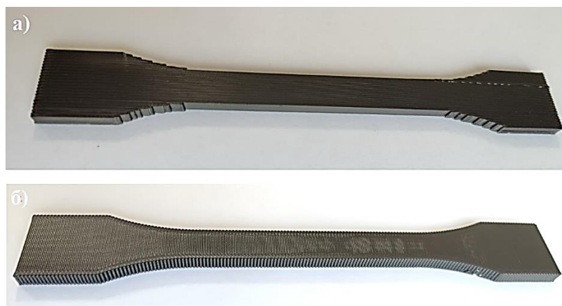
Рисунок 58 – Экспериментальные образцы, напечатанные при различных значениях угла наклона раstra: а-0°; б-90°
