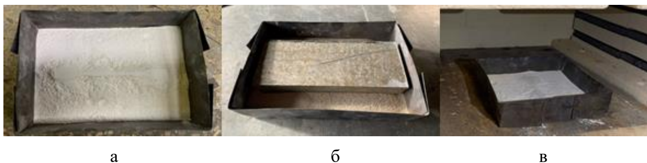
Рисунок 75 – Термическая постобработка: а – образец в дисперсной среде; б – образец в дисперсной среде с давлением; в – образцы в муфельной печи
