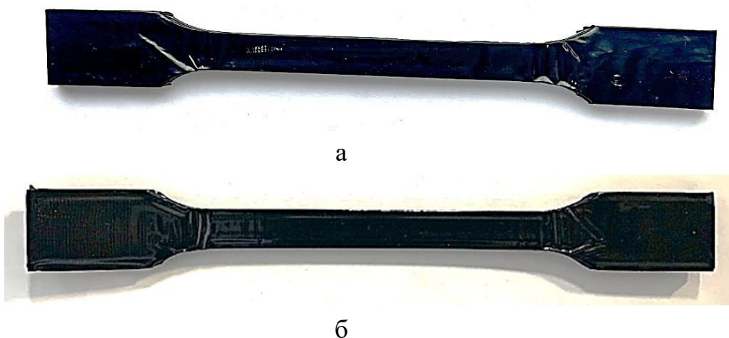
Рисунок 91 – Образцы, изготовленные методом FDM печати, где: а - 0°; б - 90°
