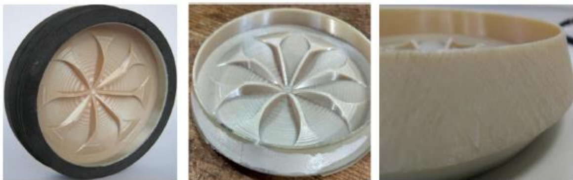
Рисунок 7 – Заглушка сопла «мембранного» типа, изготовленная с помощью FDM-печати [46]
