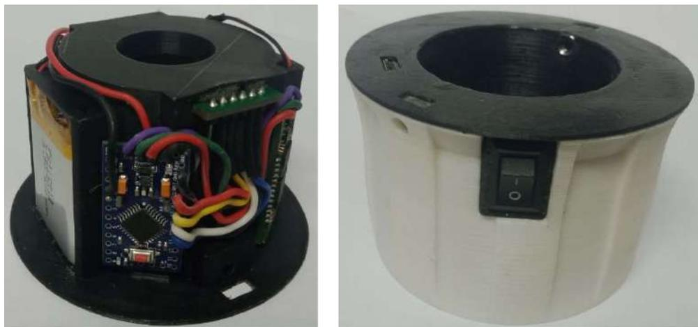
Рисунок 3.8 – Устройство контроля вибрации
