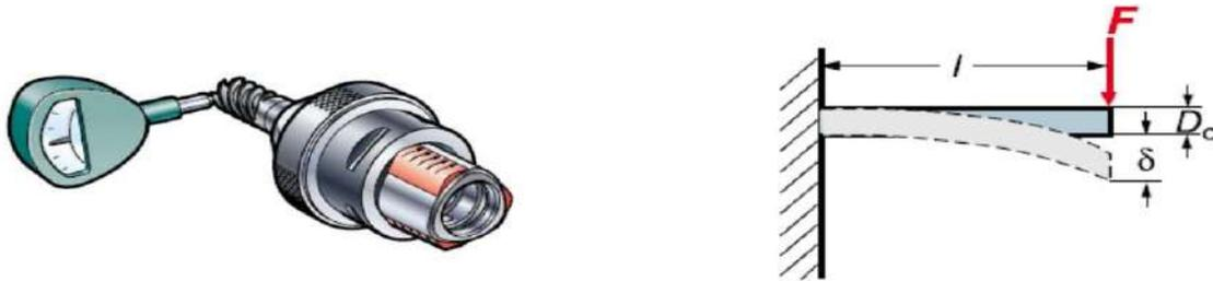
Рисунок 4.1 – Метод определения прогиба режущего инструмента
