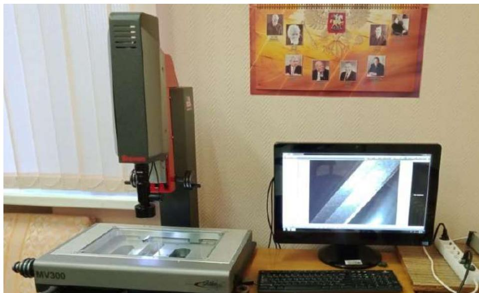
Рисунок 3.12 – Измерительный микроскоп MV300 Manual Vision System
