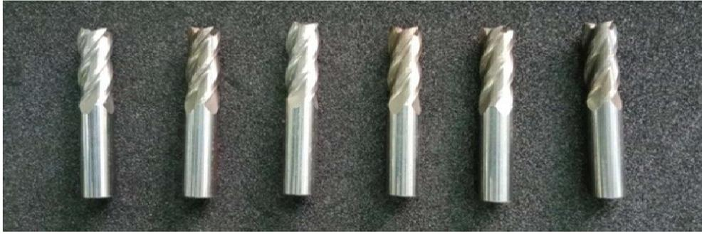
Рисунок 3.10 – Концевые фрезы
