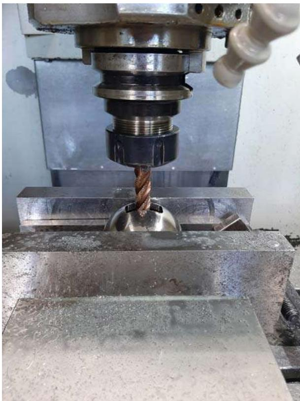
Рисунок 4.7 – Процесс обработки паза детали «Пробка» на вертикально-фрезерном обрабатывающем центре с ЧПУ FADAL VMC 6030
