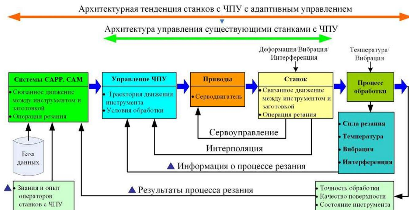
Рисунок 1.10 – Тенденции развития станков с ЧПУ с адаптивным управлением:
