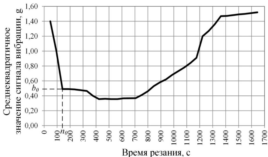
Рисунок 3.28 – Зависимость среднеквадратичного значения сигнала вибрации от числа рабочих ходов при концевом фрезеровании заготовки из нержавеющей стали 12Х18Н10Т
