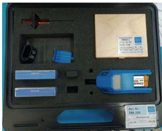
Рисунок 3.13 – Мобильный профилометр Hommel Tester T500
