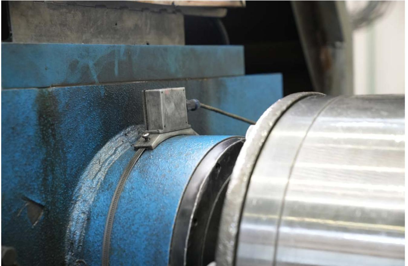
Рисунок 2.16 – Разработанный датчик вибрации, установленный на корпусе подшипника шпинделя горизонтального давяльно-раскатного стана RL-60/75
