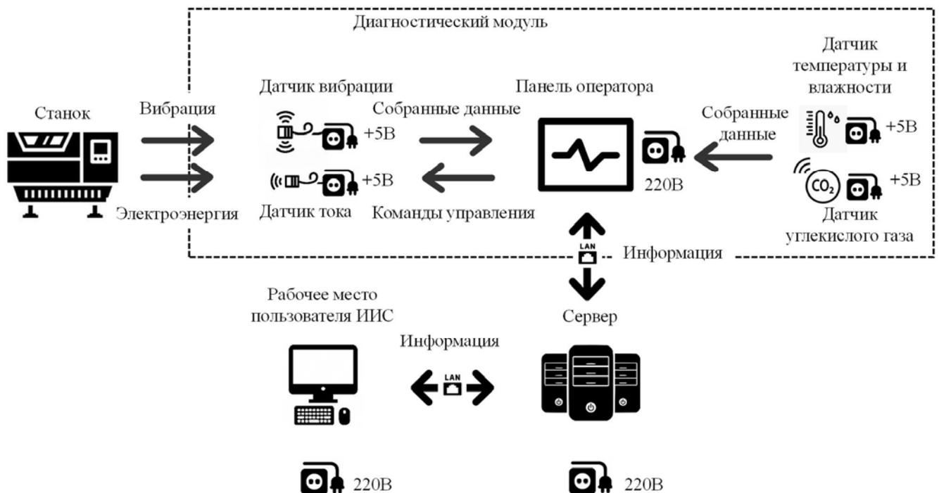
Рисунок 2.25 – Структура диагностического модуля
