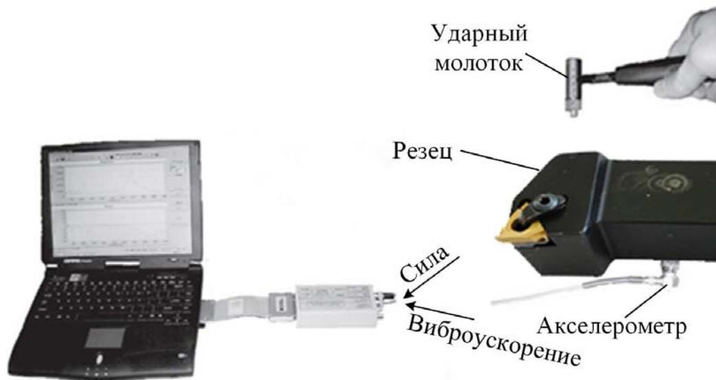
Рисунок 5.7 – Схема установки для проведения модального теста
