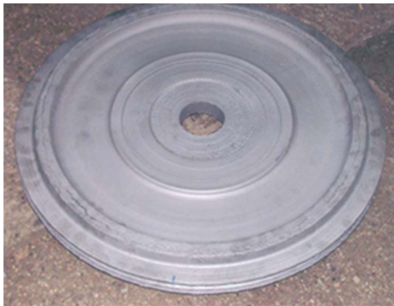
Рисунок 8 – Раскатанная заготовка диска из сплава ВТ18У
