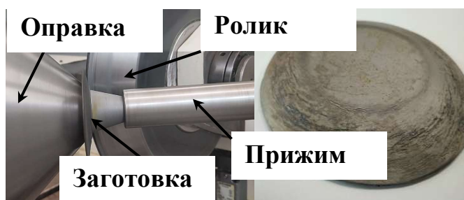
Рис. 19. Ротационная вытяжка заготовки детали «обтекатель» и заготовка после ротационной вытяжки
