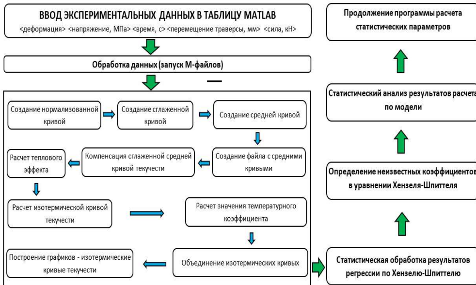
Рис. 13. Схема построения «изотермической» кривой текучести титана BT1-0
