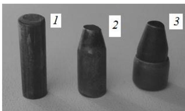
Рис. 17. Заготовка (1), полуфабрикат (2) и вариант пули (3) с сердечником в сборе, изготовленные по существующей технологии
