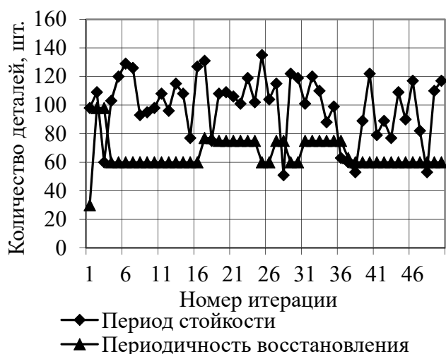
Рисунок 10 – Реализации периодов стойкости лезвийного инструмента, учитываемые в процессе оптимизации, и значения оптимальной периодичности восстановления t_{\text{опт}} в зависимости от номера итерации в процессе статистической адаптации
