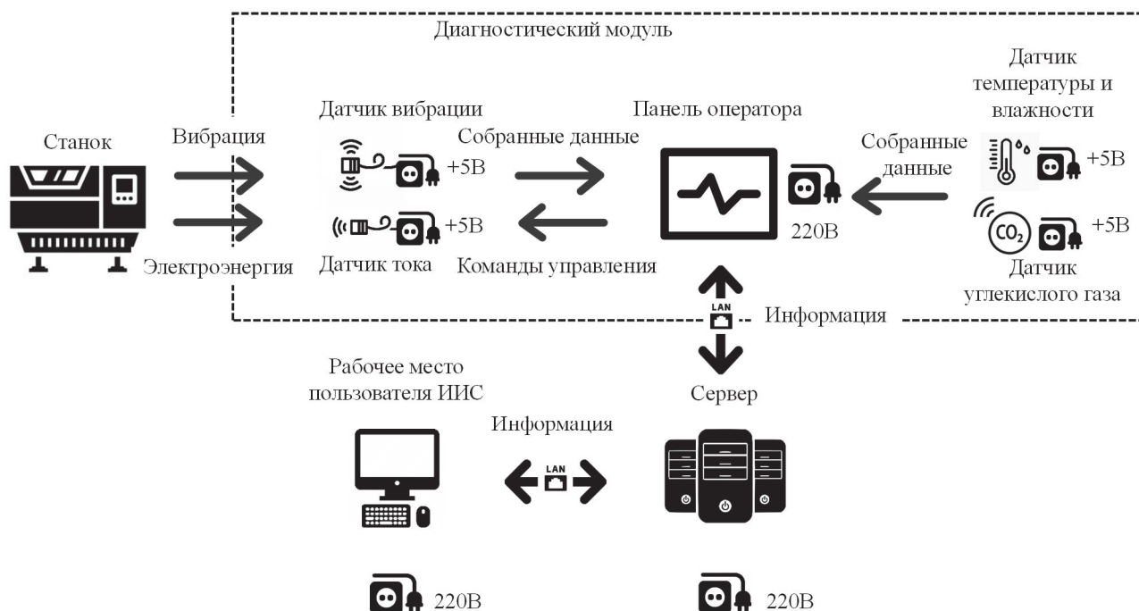
Рисунок 6 – Структура диагностического модуля
