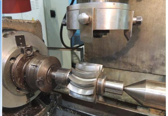
Рис. 8 – Обработка модифицированных зубьев шестерни на четырёхкоординатном станке ОЦ-1И22
