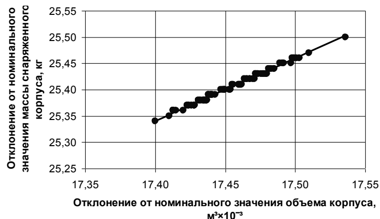
Рис. 3 Графическое представление уравнения регрессии объема корпуса от его массы
