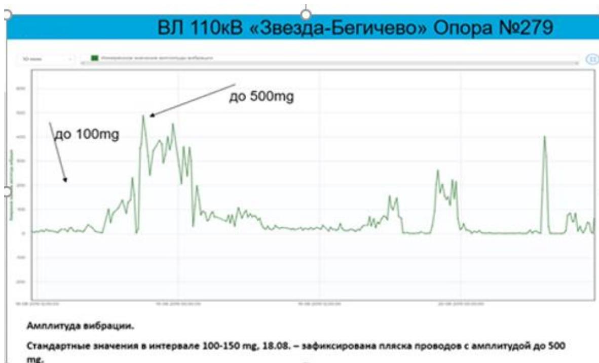
Рисунок 5.3.2 – Блок дистанционного мониторинга на ВЛ 110 кВ «Звезда – Бегичево» (амплитуда вибрации)
