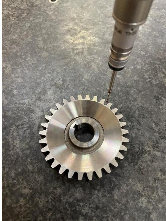
Рисунок 3.8 – Перемещение измерительного наконечника КИМ в опорную точку контрольной впадины  $K_2$
