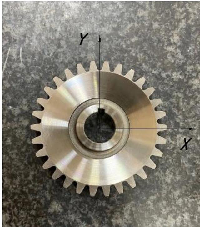
Рисунок 3.4 – Рекомендуемое расположение контролируемого зубчатого колеса на измерительном столе КИМ
