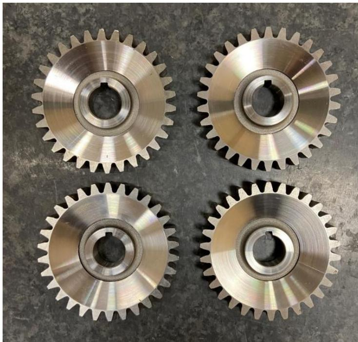
Рисунок 4.16 – Группа контролируемых зубчатых колес
