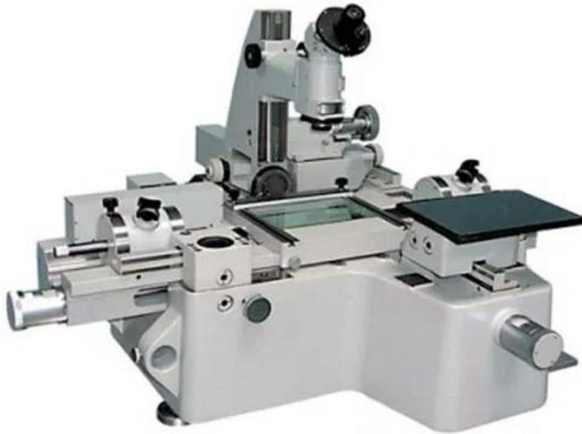
Рисунок 1.14 – Инструментальный измерительный микроскоп УИМ-21
