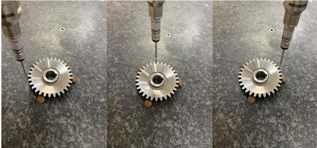
Рисунок 3.10 – Процесс измерения зубчатого колеса
