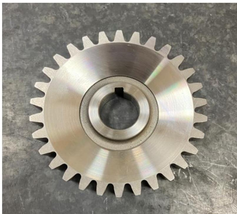
Рисунок 4.10 – Контролируемое зубчатое колесо №1
