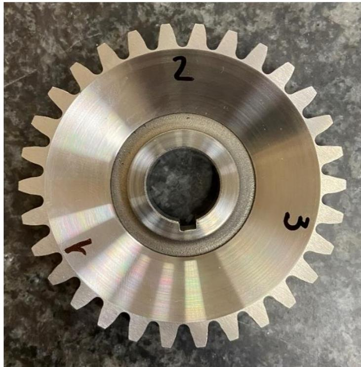
Рисунок 4.13 – Вариант расположение «базовых» боковых поверхностей
