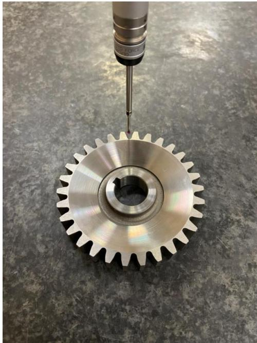
Рисунок 3.7 – Положение измерительного наконечника КИМ перед измерением первой впадины зубчатого колеса
