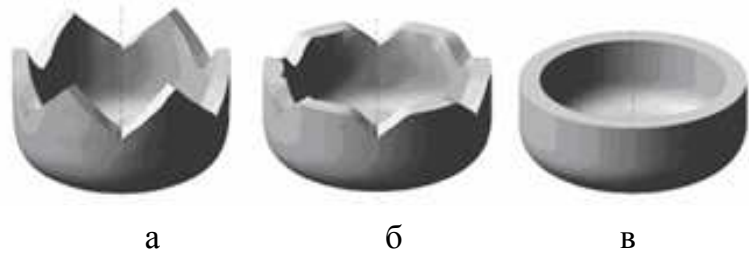
Рисунок 3 – Поэтапное деформирование при осадке корончатого венца:
