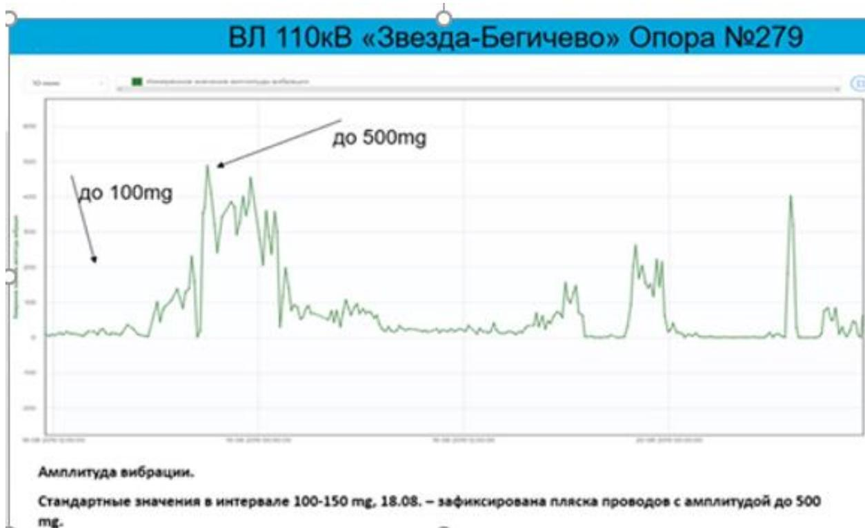
Рисунок 2 – Блок дистанционного мониторинга на ВЛ 110 кВ «Звезда – Бегичево» (амплитуда вибрации)
