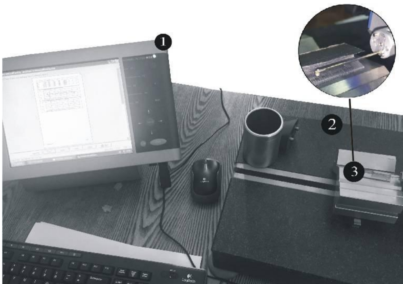
Рис. 4.20. Измерения шероховатости и волнистости боковой поверхности зубьев экспериментальных образцов:
