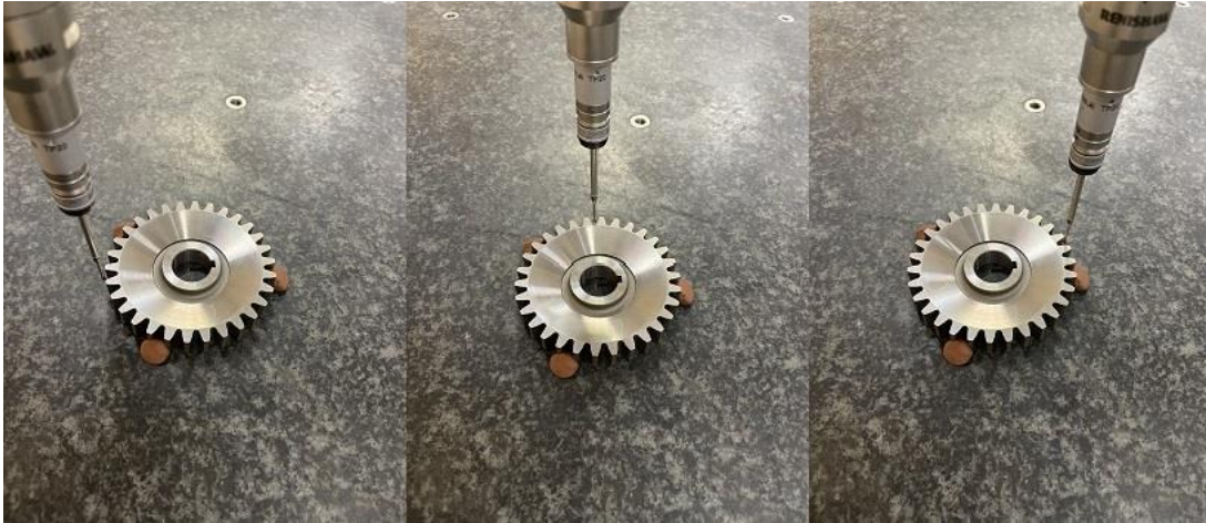
Рисунок 5 – Процесс измерения зубчатого колеса
