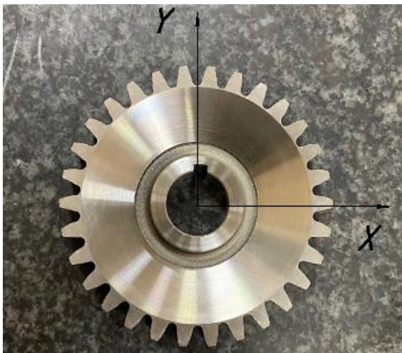
Рисунок 2 – Расположение зубчатого колеса на измерительном столе
